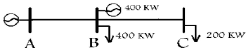
شکل ۳-۱۲. فیدر شعاعی با منبع ۴۰۰ کیلوواتی در باس B [۹].
