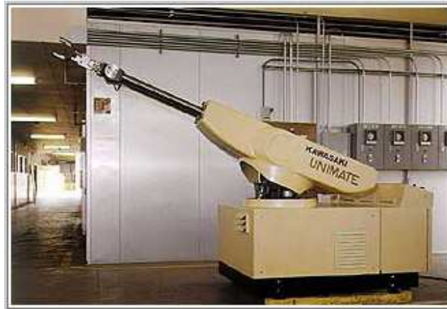
شکل (۳-۲): ربات یونیمیت با پیکربندی کروی [۵۹]
