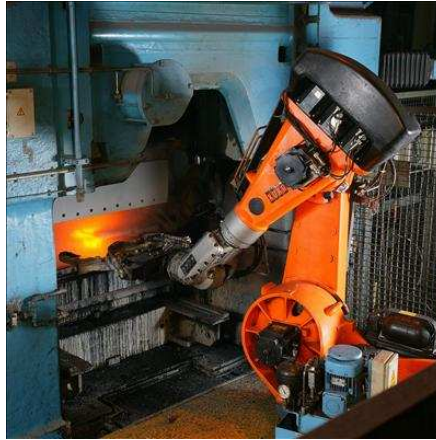
شکل (۲-۲): ربات با پیکربندی هنرمند [۵۹]
