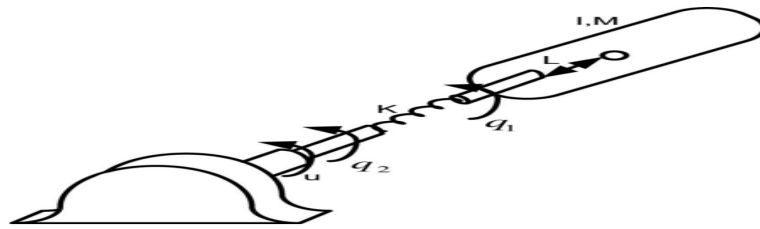
شکل (۱-۴): ربات با مفصل انعطاف پذیر یک درجه آزادی [۵۹]
