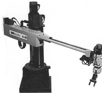
شکل (۵-۲): بازوی ربات با پیکربندی استوانه‌ای [۵۹]
