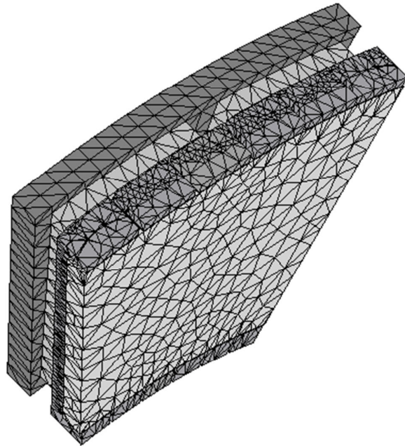
شکل (۳-۵): مش‌بندی انجام شده روی یک جفت قطب از موتور AFPM مورد بررسی
