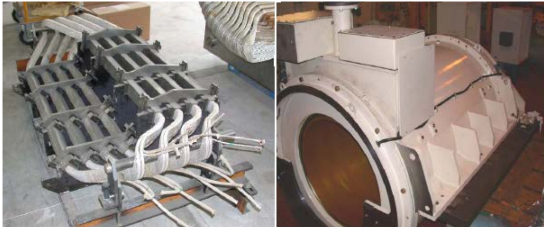
شکل ۳-۶- استاتور هسته هوایی بدون حضور دندانه (سمت راست)، سیم‌پیچ به همراه نگه‌دارنده (سمت چپ)
