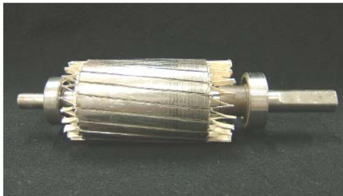
شکل ۳-۸- روتور ابررسانای موتور القایی ابررسانا
