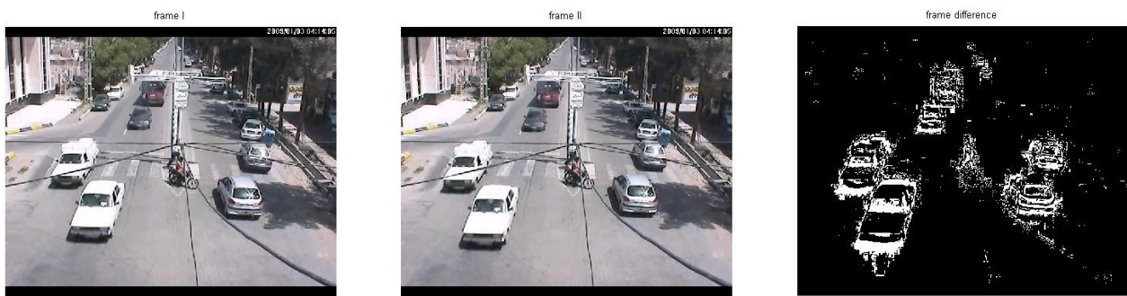
شکل ۲-۲: تشخیص خودرو با استفاده از روش تفاضل فریم‌های متوالی
