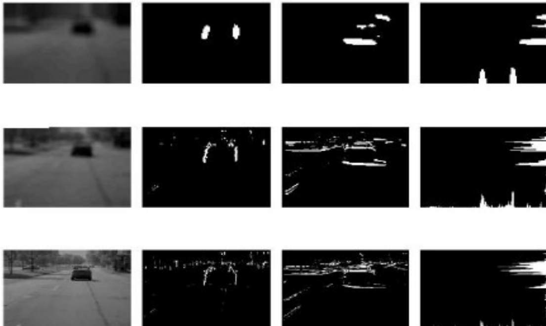
شکل ۲-۸: تاثیر عملگر لبه: ستون ۱، تصویر با سایزهای مختلف با استفاده از یک فیلتر پایین‌گذر بدست آمده است. در ستون ۲ و ۳ لبه‌های عمودی و افقی دیده می‌شود. در ستون ۴، پروفایل‌های عمودی و افقی تصاویر نشان داده شده است.
