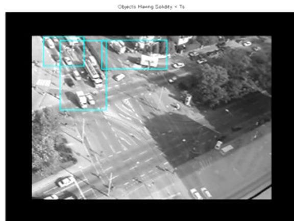
شکل ۴-۲۹: (الف و پ) خروجی GMM (ب و ت) خطای تشخیص و ردیابی در سیستم پیشنهادی همانطور که در تصویر ذیل مشاهده می‌گردد، پیچیدگی تصویر به حدی بالا می‌باشد، که واحد همپوشانی را با خطاهایی مواجه نموده است:
