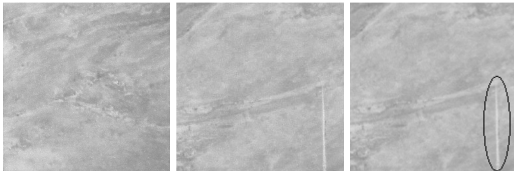
شکل (۱-۵) : نمونه‌ای از یک بافت تصادفی سالم (سمت چپ) و نمونه‌ی معیوب آن (وسط و سمت راست) [۱۷].
