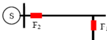
شکل (۲-۳-الف): هماهنگی فیوز - فیوز [۹]، [۱۳]
