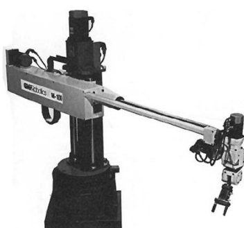
شکل ۲-۱۰ بازوی ربات با پیکربندی استوانه‌ای
