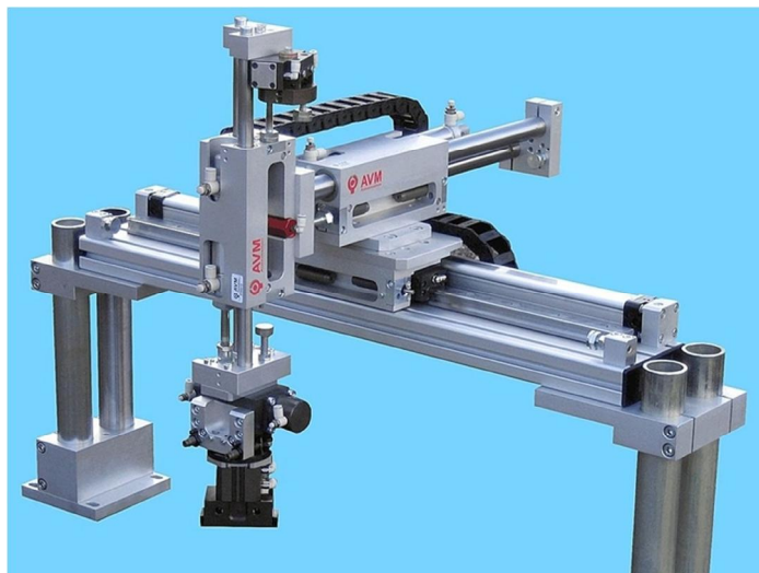
شکل ۱۰-۲ ربات با پیکربندی دکارتی
