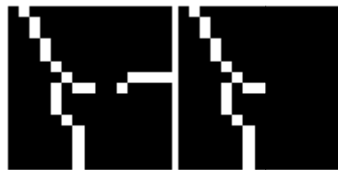
شکل ۵-۲۷: پنجره‌ای به ابعاد 15 \times 15 (الف) شامل دو مولفه از نقاط ناودانی بیرون، (ب) مولفه موثر در تعیین ناحیه محتمل رشد.
