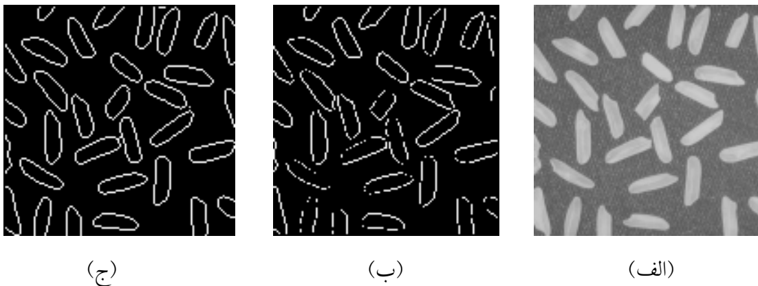
شکل ۲-۴: (الف) یک تصویر نمونه (ب) تصویر دو سطحی شده حاصل از اعمال ماسک های سوبل بر روی تصویر "الف". (ج) تصویر مرز نواحی حاصل از پیوند لبه
