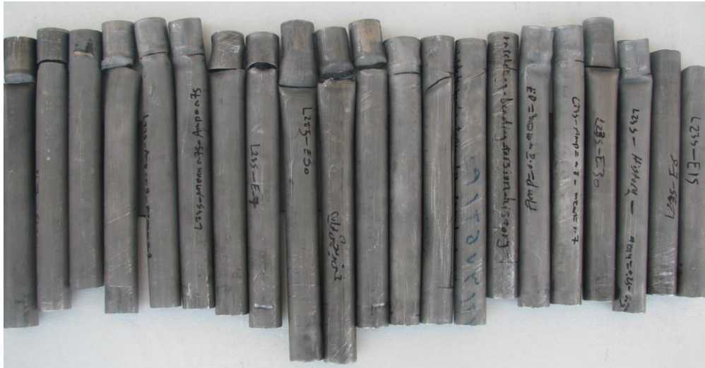
شکل ۳-۳۳: وضعیت شکست تعدادی پوسته استوانه‌ای بعد از انجام آزمایش بارگذاری خمشی و مرکب سیکلی
