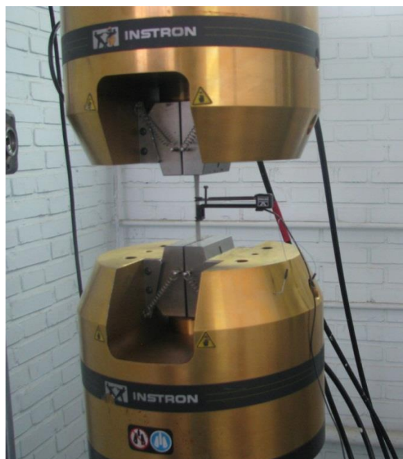
شکل ۳-۱: آزمایش کشش استاندارد با استفاده از دستگاه اینسترون ۸۸۰۲
