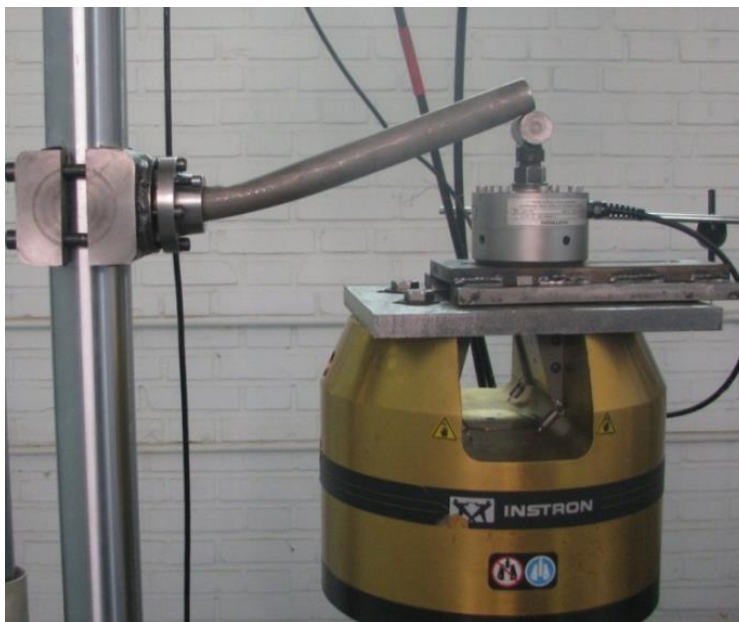
شکل ۳-۴: آزمایش پوسته استوانه‌ای تحت بارگذاری خمشی ساده
