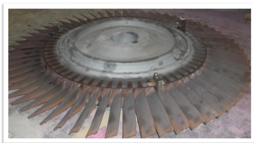
شکل ۱-۳: دیسک توربین گاز واحدهای نیروگاه گازی ۷۹۴ ساخت شرکت آنسالدور
