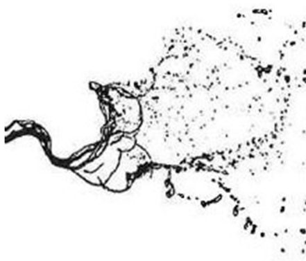
شکل (۵-۲۴) شکست تزریق از نوع غشایی
