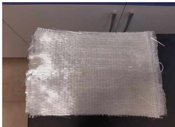
شکل (۳-۲): الیاف شیشه نوع E-glass تک جهته مورد استفاده در ساخت رویه ساندویچ پانل.
