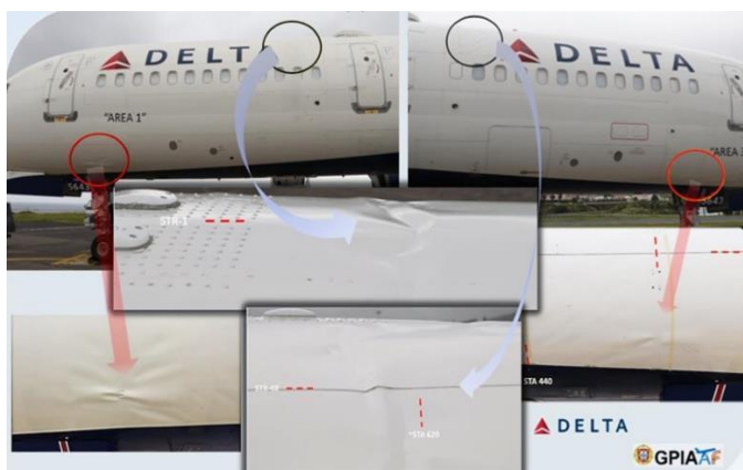
شکل (۸-۱): کمانش پوسته بدنه هواپیما Delta-757 [۱۰].
