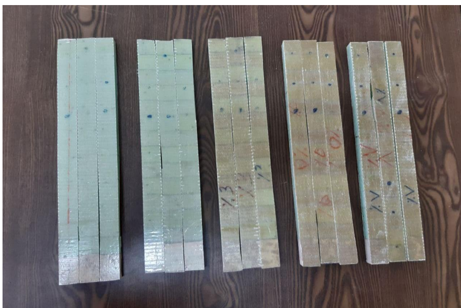
شکل (۳-۲۲): نمونه‌های پنل ساندویچی، از سمت چپ: هسته ساده، هسته زیگزاگی، هسته زیگزاگی حاوی ۳٪ نانو ذره خاک رس، هسته زیگزاگی حاوی ۵٪ نانو ذره خاک رس، هسته زیگزاگی حاوی ۷٪ نانو ذره خاک رس.
