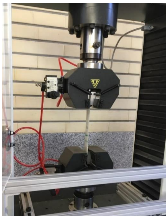
شكل (۳-۲۲): دستگاه سنتام آزمون كشش پوسته كامپوزيتى شيشه/اپوكسى.
