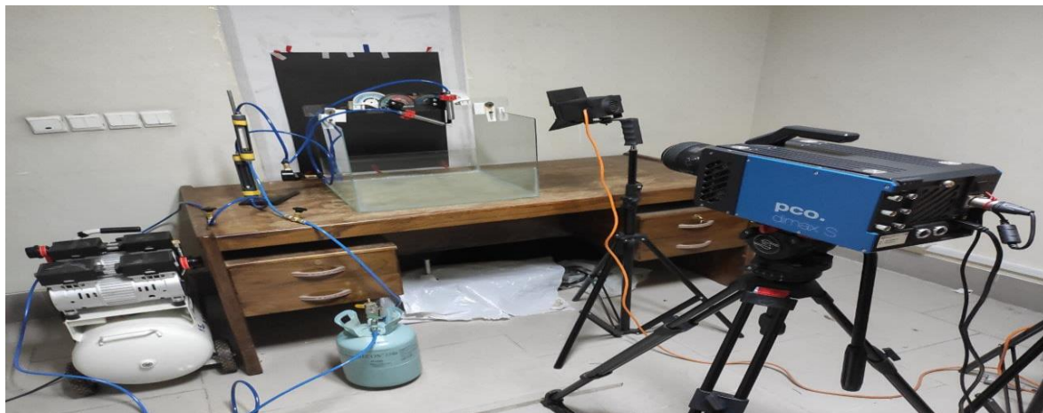
شکل ۳-۱- سیستم سیال‌رسانی به جت‌ها و نحوه‌ی جایگیری منبع نوری و دوربین سرعت بالا
