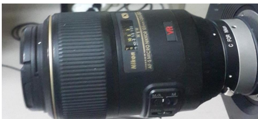
شکل ۳-۴- لنز مورد استفاده ۱۰۵ میلی متر ساخت نیکون
