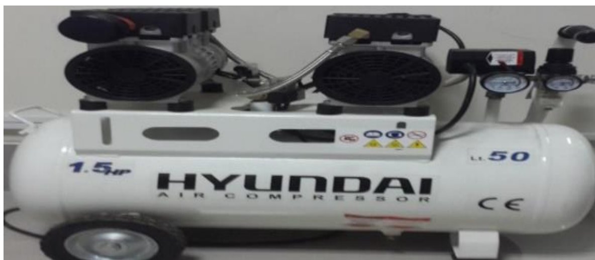
شکل ۳-۹- کمپرسور هوای ۱/۵ اسب بخار شرکت HYUNDAI
