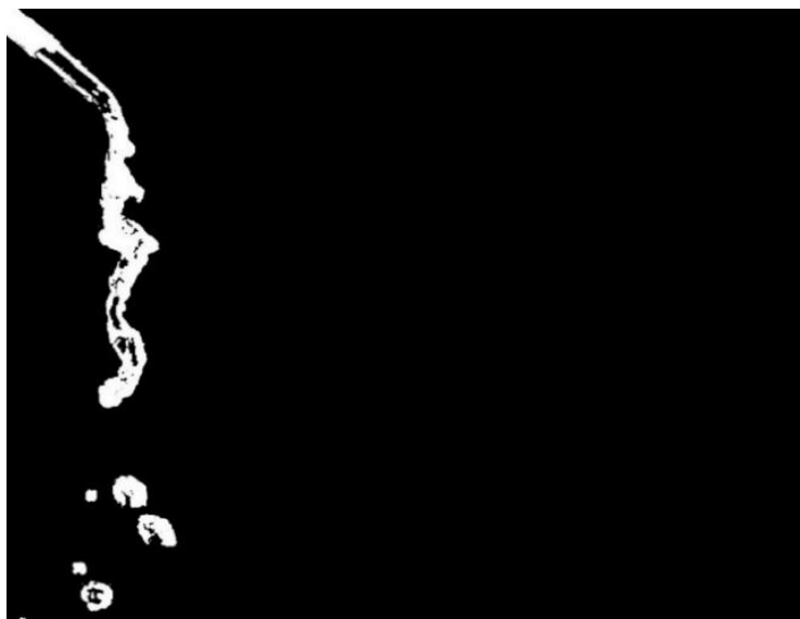
شکل ۴-۸- فرآیند پردازش تصویر فرآیند فروپاشی جت آب
