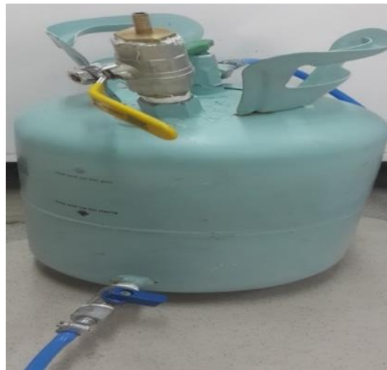
شکل ۳-۱۰- مخزن پرفشار آب
