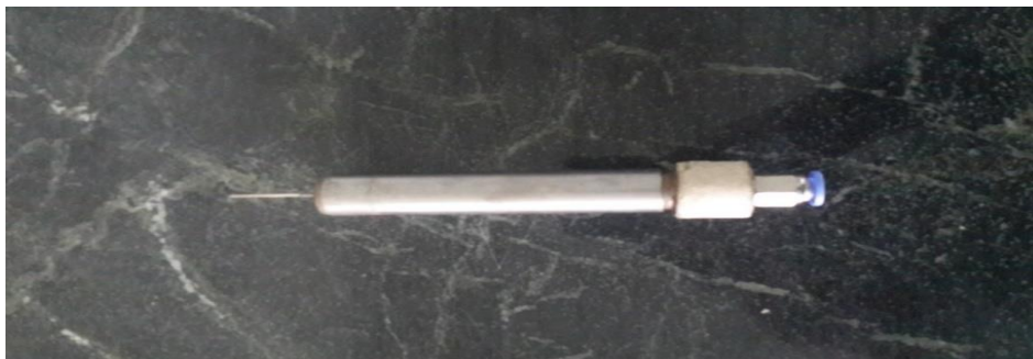
شکل ۳-۶- انژکتور ساخته شده برای دو جت هوا و آب
