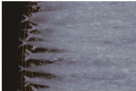
شکل ۱-۶- حضور انژکتورهای برخوردی در موتور F-1 در مرحله اول پرتاب Saturn V [۱۰]
