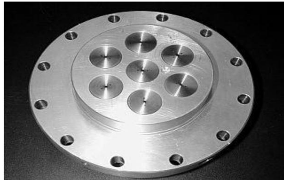
شکل ۱-۵- صفحه انژکتور موتور سوخت مایع [۹]
