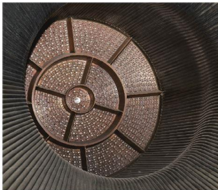
شکل ۱-۶- حضور انژکتورهای برخوردی در موتور F-1 در مرحله اول پرتاب Saturn V [۱۰]
