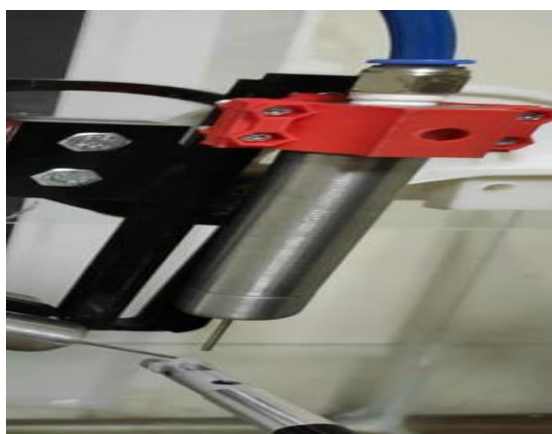
شکل ۳-۱۲- نحوه اندازه‌گیری سرعت هوا در نقطه برخورد دو جت
