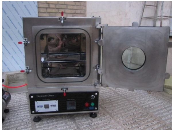
شکل ۲-۲: یک آون خلاء با هندسه مکعبی
