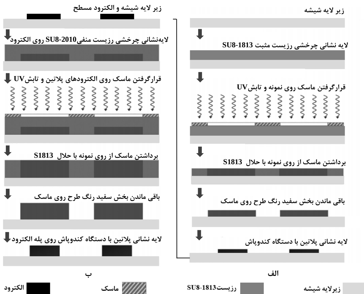
شکل (۵-۵). مراحل ساخت الکتروود (الف) الگو کردن الکتروود پلاتین بر روی شیشه (ب) ساخت پله SU8 بر روی الکتروود
