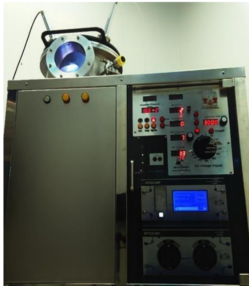
شکل (۴-۵). دستگاه لایه‌نشانی کندوپاش
