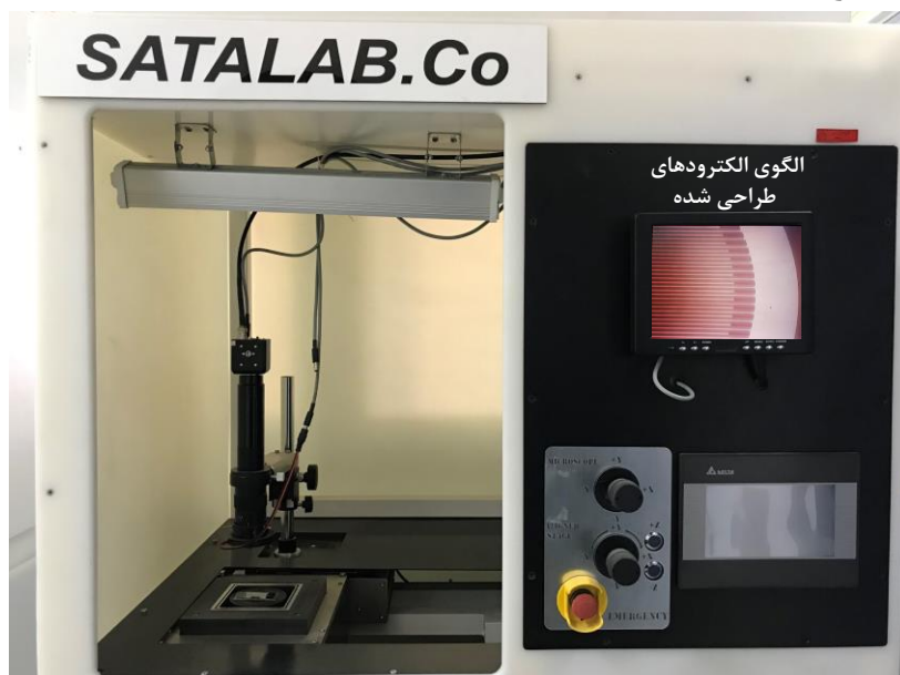
شکل (۳-۵). دستگاه لیتوگرافی توسط فوتورزیست مثبت یا منفی بر روی زیرلایه های شیشه، سیلیکون
