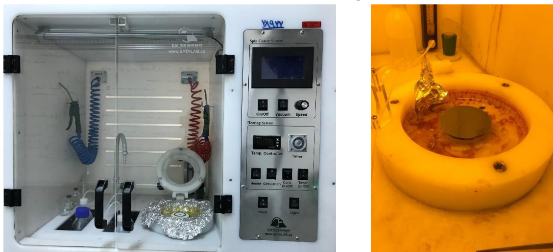
شکل (۶-۵). لایه‌نشانی چرخشی برای ایجاد ضخامت فوتورزیست
