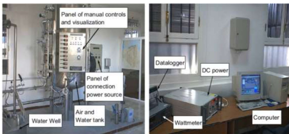
شکل ۱۴-۲ تجهیزات تست آزمایشگاهی سیستم پمپ فتوولتاییک هامیدت به منظور بهینه‌سازی احتمال از دست دادن بار
