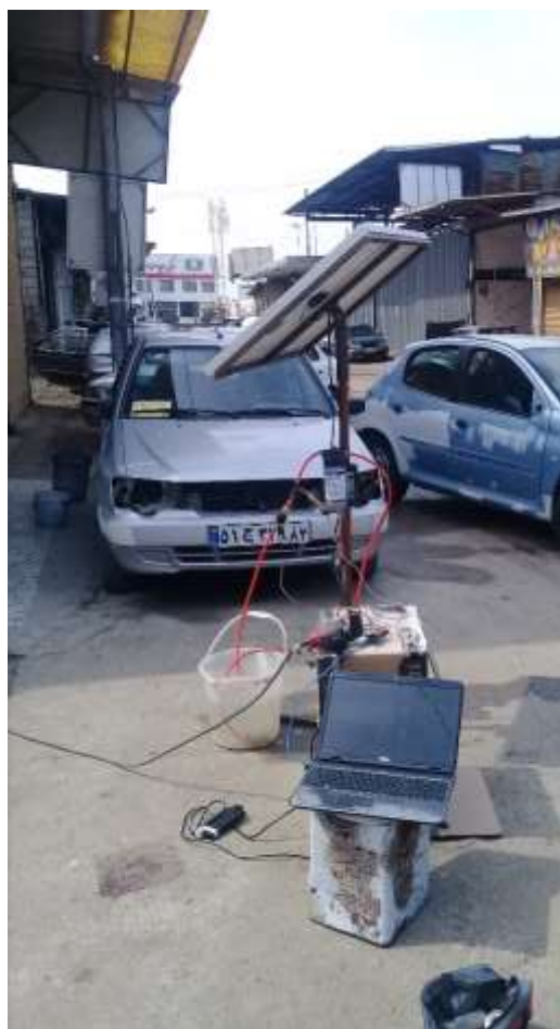
شکل ۴-۵ ساخت استند تست و انجام تست داده برداری بدون اتصال به سیستم قطره چکان
