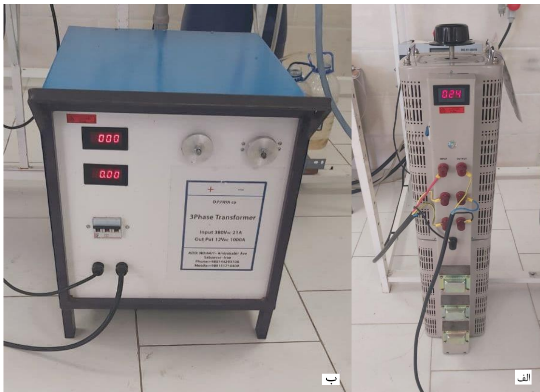
شکل ۳-۱۵ (الف) منبع تغذیه سه فاز (ب) دستگاه ترانس کاهنده
