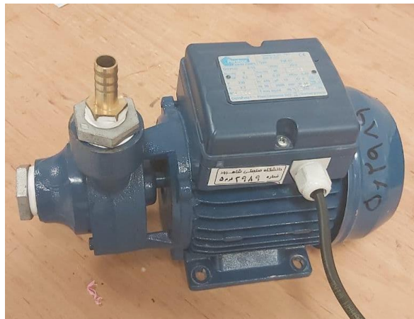
شکل ۳-۶ پمپ آب شور مدل PM45 با توان نیم اسب
