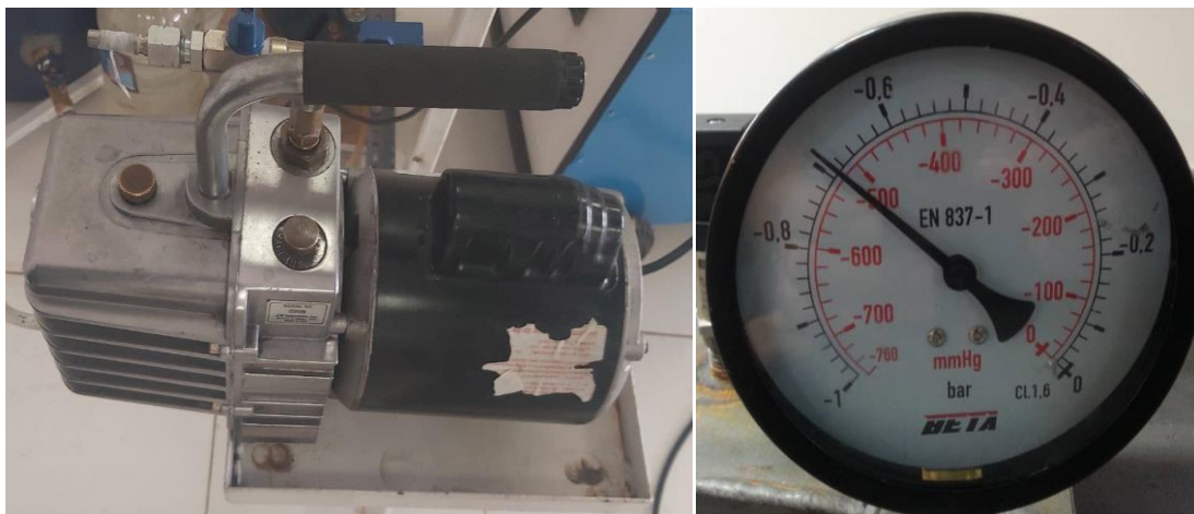
شکل ۳-۱۲ (الف) گیج فشار Beta (ب) پمپ وکیوم مدل 90066
