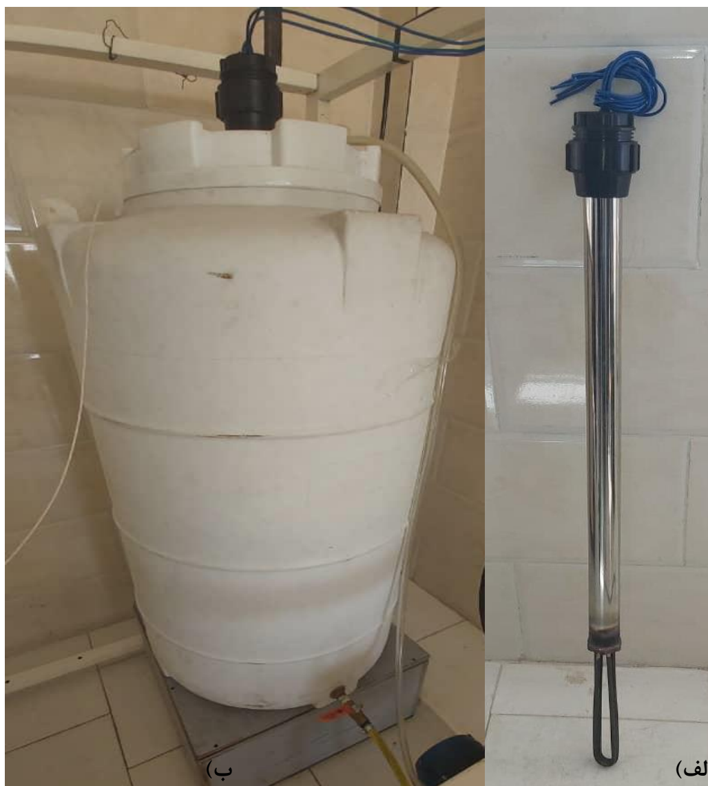
شکل ۳-۳ مجموعه مخزن و المنت (الف) المنت در خارج آب (ب) المنت در داخل مخزن آب
