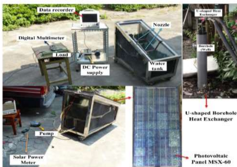
شکل ۲-۳۱. عکس واقعی سیستم آزمایشگاهی استفاده از روش اسپری کردن آب برای خنک سازی ماژول فتوولتائیک [۷۰].
