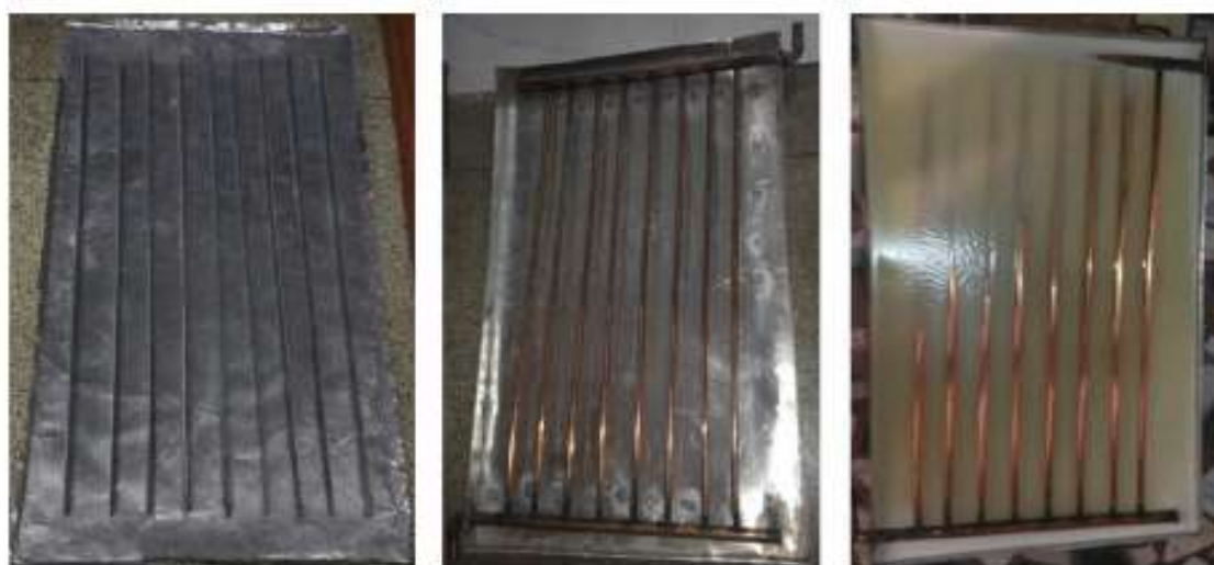
شکل ۲-۹. روش استفاده از PCM در محفظه پشت ماژول [۳۷].
