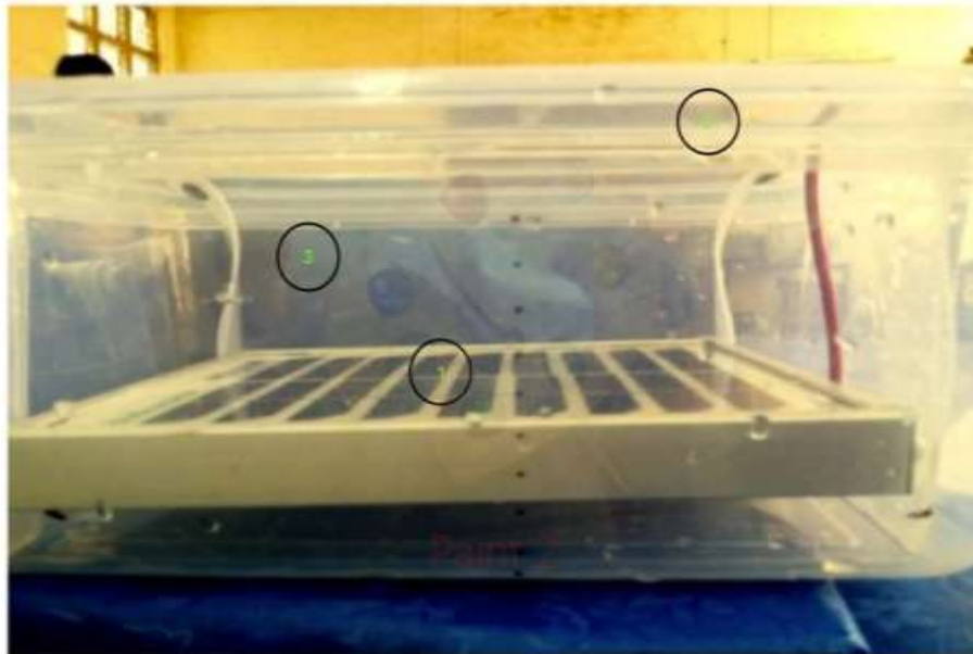
شکل ۲-۱۰. روش غوطه‌ور سازی ماژول خورشیدی در آب [۳۹].
