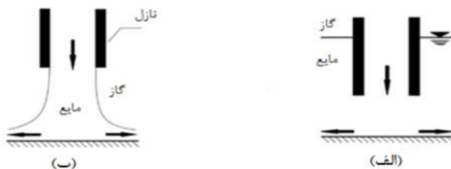
شکل ۲- ۱۸. (الف) نمایی از جت غوطه‌ور، (ب) جت سطح آزاد [۶۰].
