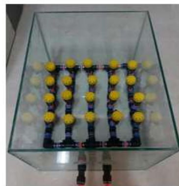
شکل ۳-۵. (الف) چیدمان سیستم جت با نازل‌های تک سوراخه (ب) چیدمان سیستم جت با نازل‌های ۸ سوراخه
