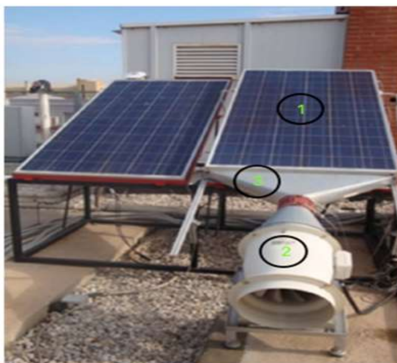
شکل ۲- ۱۳. گردش اجباری هوا در پشت ماژول به منظور خنک سازی آن [۴۱].
