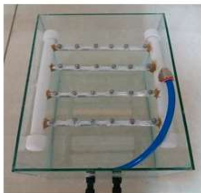
شکل ۳-۵. (الف) چیدمان سیستم جت با نازل‌های تک سوراخه (ب) چیدمان سیستم جت با نازل‌های ۸ سوراخه
