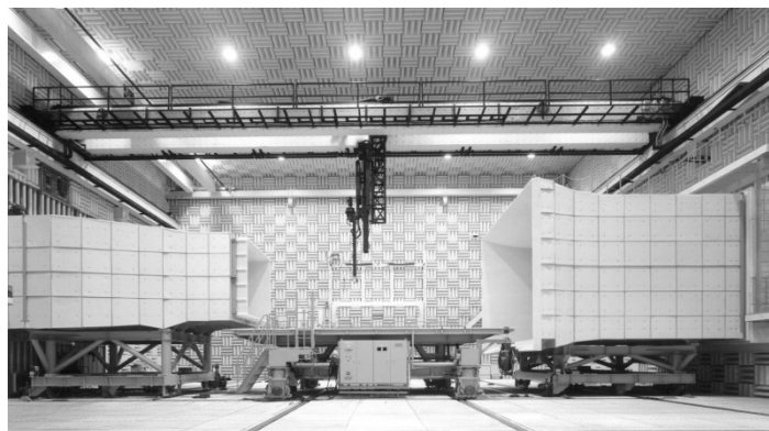
شکل (6-3) تونل باد مدار بسته با اتاق آزمون باز
