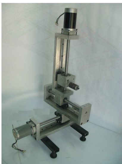
شکل (3-18) مکانیزم انتقال دهنده پراب
