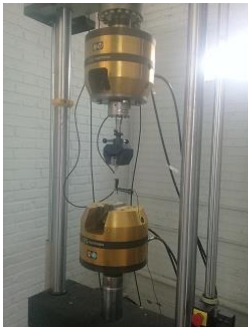
شکل ۳-۱۸ آزمون کشش هسته‌ی کامپوزیتی
