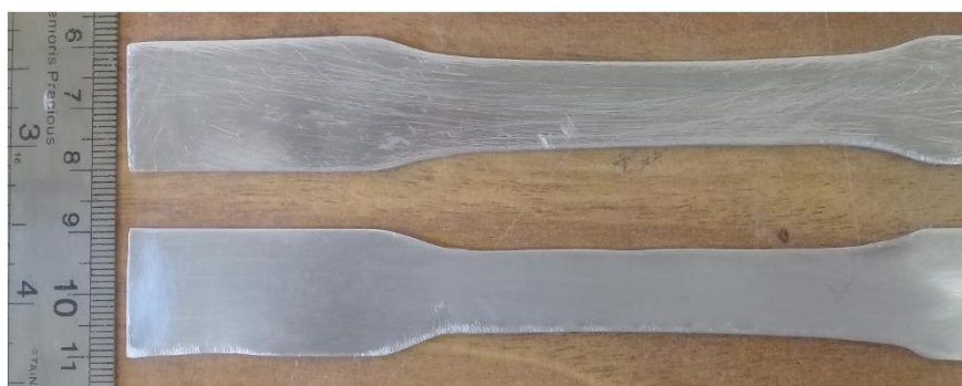
شکل ۳-۱ نمونه‌های آزمون کشش ورق آلومینیوم
