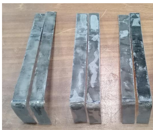
شکل ۴-۲۸ نمونه‌های حاوی نانوگرافن اکسید پس از آزمون پوست کنی
