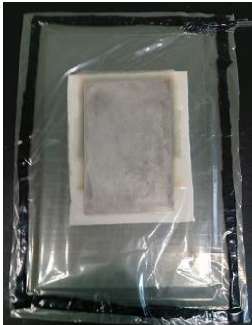
شکل ۳-۱۶ نمونه‌ی FML ساخته شده برای آزمون خستگی
