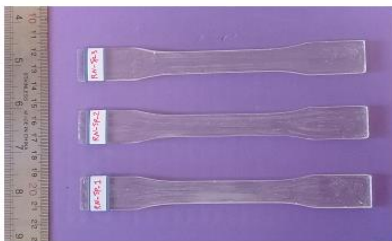
شکل ۳-۸ نمونه‌های آزمون کشش رزین اپوکسی بدون نانو گرافن اکسید
