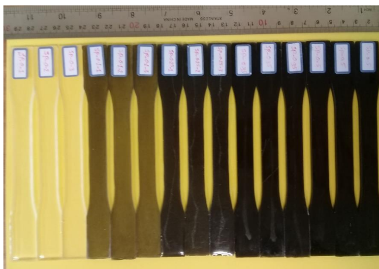
شکل ۳-۹ نمونه‌های ساخته شده با درصدهای مختلف نانوگرافن اکسید
