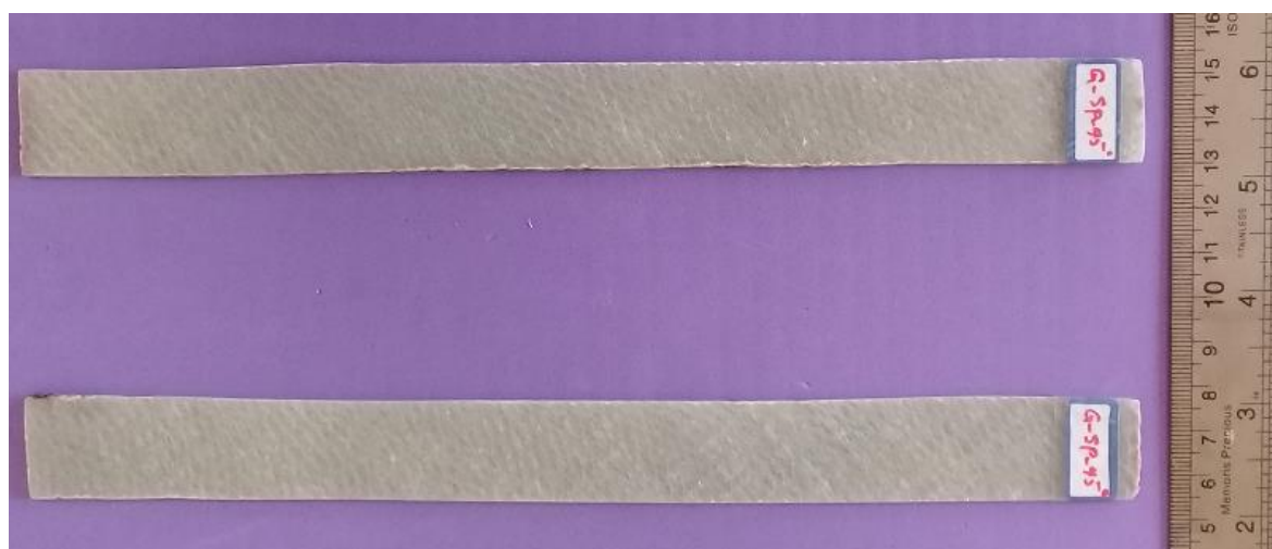
شکل ۳-۱۲ نمونه‌های آزمون کشش هسته‌ی کامپوزیتی با زاویه‌ی الیاف ۴۵ درجه
