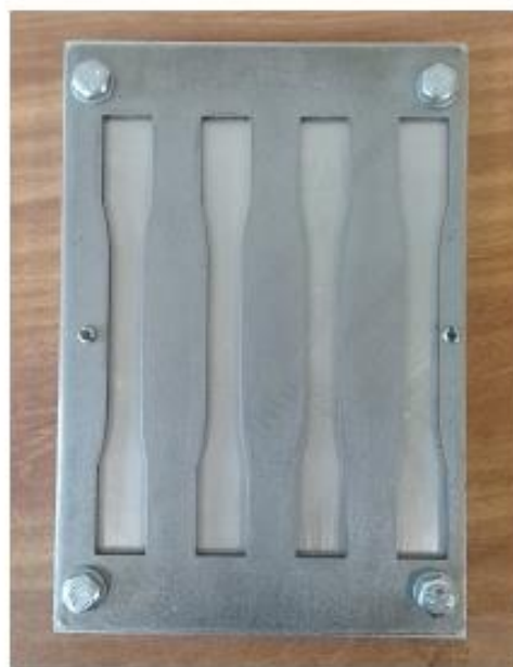
شکل ۳-۷ قالب آلومینیومی برای ساخت نمونه‌ی کشش رزین
