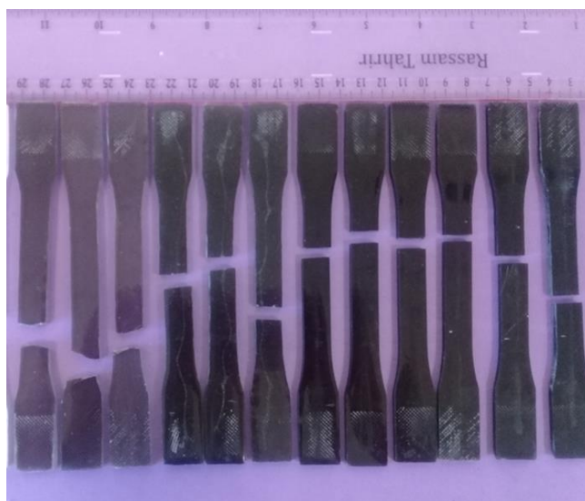
شکل ۴-۳ نمونه‌های رزین اپوکسی با درصدهای مختلف گرافن اکسید پس از انجام آزمون
