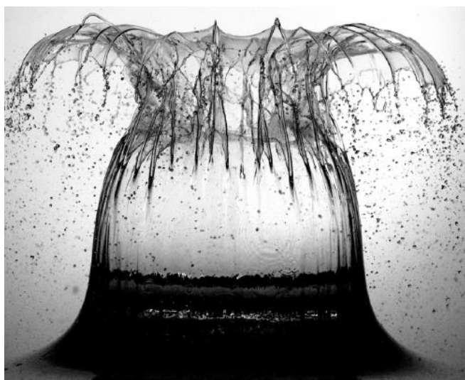
شکل ۲-۲: تشکیل پرده پاششی تاجی شکل در اثر برخورد گوی به سطح سیال C_6F_{14} [۴۲]
