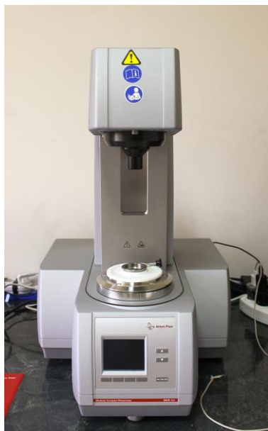
شکل ۲-۲۱: ویسکومتر مدل MCR302 ساخت شرکت Anton Paar
