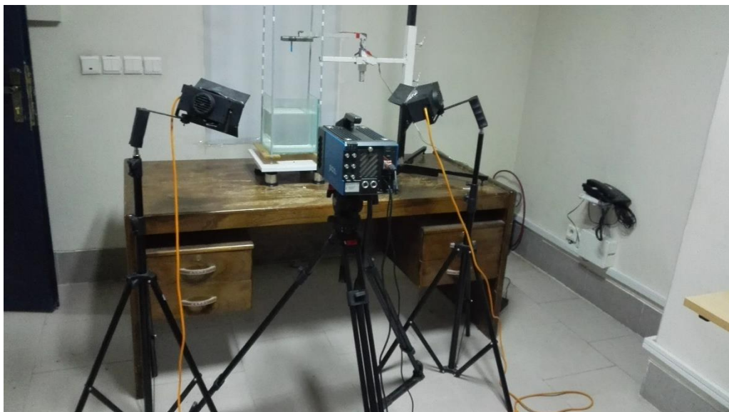
شکل ۲-۲۵: نحوه استقرار تجهیزات برای تصویربرداری
