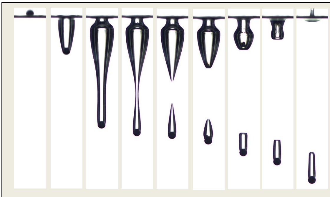
شکل ۳-۹: کاواک تشکیل شده ناشی از سقوط گوی از ارتفاع ۱۰۰ سانتی متر در سیال غیرنیوتنی
