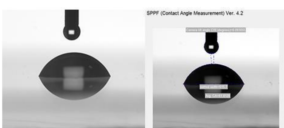
شکل ۲-۱۳: نمونه تصاویر اندازه‌گیری زاویه تماس. تصویر سمت چپ خام و تصویر سمت راست به کمک نرم‌افزار SPPF تحلیل شده‌اند.
