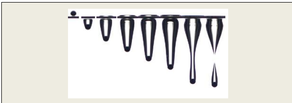
شکل ۲-۱۶: تصویر تشکیل کاواک بعد از برخورد گوی آب‌دوست به سطح محلول سیال نیوتنی
