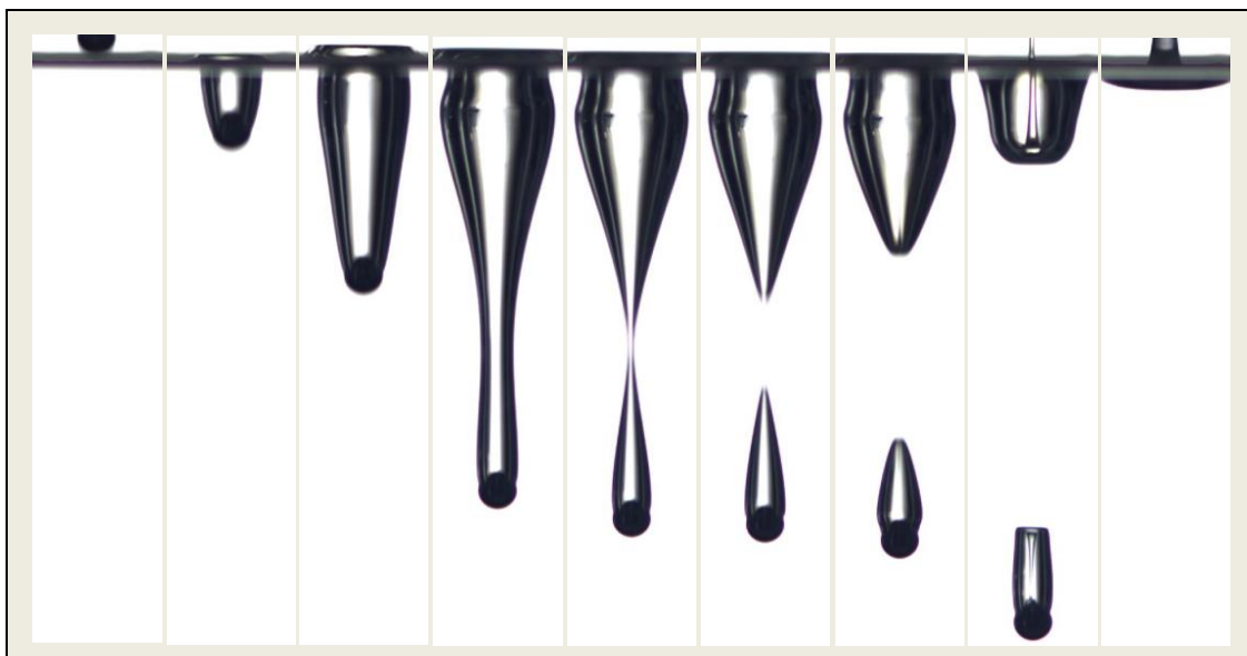
شکل ۳-۱۶: کاواک تشکیل شده ناشی از سقوط گوی آب دوست از ارتفاع ۵۰ سانتی متر در سیال نیوتنی
