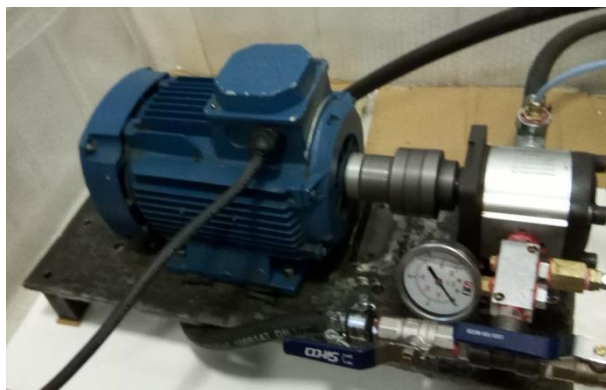
شکل ۴-۹. پمپ هیدرولیک مورد استفاده با حداکثر تحمل فشار ۲۰ بار
