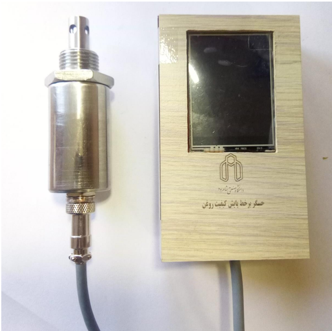
شکل ۳-۱۸. نحوه اتصال حسگر ظرفیت خازنی به برد نمایش اطلاعات حسگر
