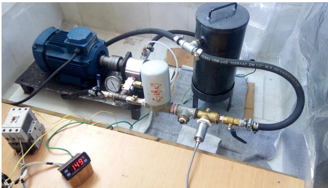
(الف) نمایی از اتصال حسگر به مدار روغن تحت دمای ۱۵۰ درجه سانتیگراد و فشار ۵ بار
