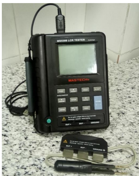
شکل ۴-۱. دستگاه اندازه‌گیری ظرفیت خازنی MS 5308 LCR TESTER
