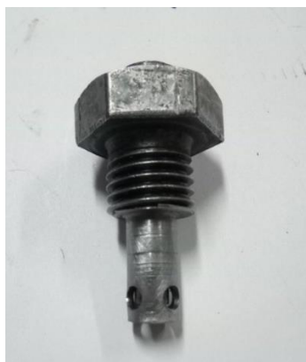
شکل ۳-۵. نمونه اولیه ساخته شده از طرح ثانویه حسگر خازنی
