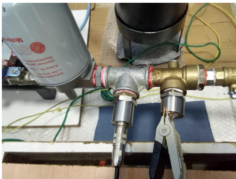
شکل ۴-۱۳. نحوه اتصال حسگر ظرفیت خازنی را به دستگاه LCR Tester به صورت برخط به همراه نصب حسگر تجاری تن دلتا
