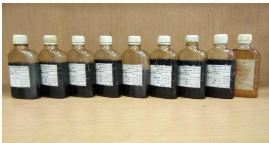
شکل ۴-۷. نمونه های روغن گرفته شده در آزمون رسوبات روغن در یک دوره ۷۲ ساعته از کارکرد موتور
