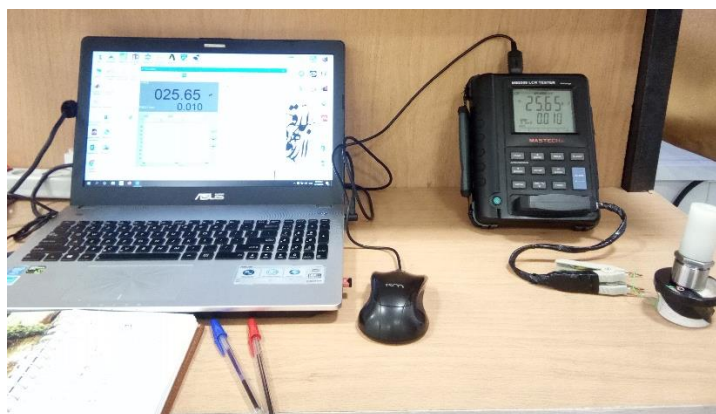
شکل ۴-۲. نحوه اتصال حسگر به دستگاه اندازه‌گیری ظرفیت خازن در حالت خارج از مدار
