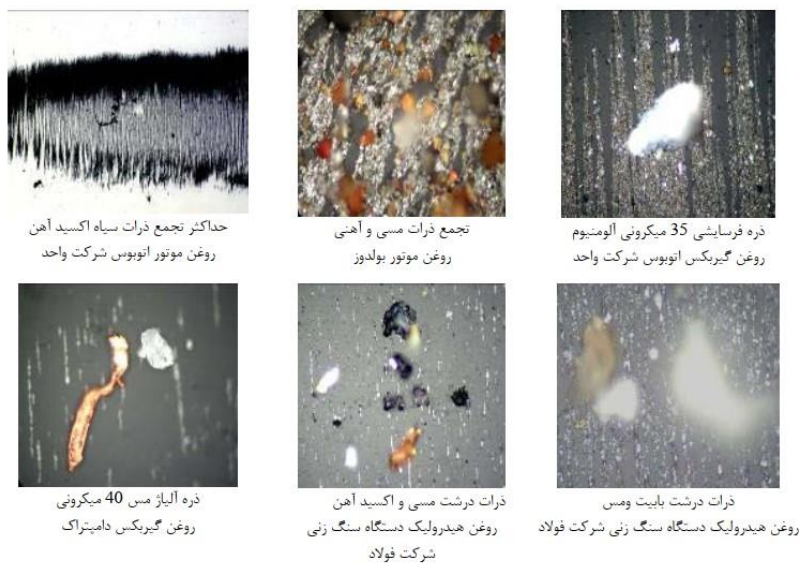
شکل ۲-۳. چند نمونه از تصاویر ذرات سایشی بدست آمده از فروگرافی [۳۸]
