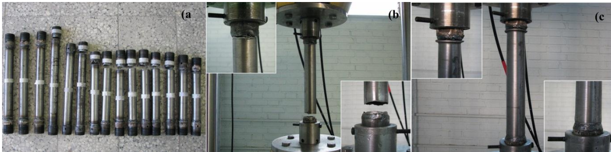
شکل ۳-۲۵: (a) تعدادی از پوسته های استوانه ای تست شده (b) شکست نمونه در مجاورت جوش فیکسچرها (c) کمانش نمونه در مجاورت جوش فیکسچرها.
