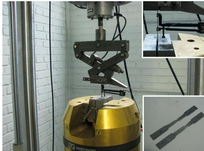
شکل ۳-۲: استفاده از نیروسنج ۲۵kN و طول سنج برای تست کشش استاندارد.
