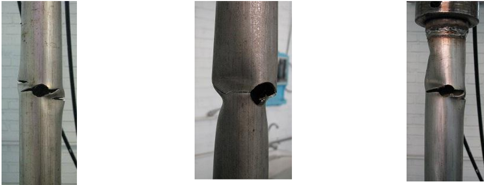
شکل ۳-۳۷: رفتار پوسته های استوانه ای به طول 250\text{mm} در مجاورت گشودگی تحت بارگذاری جابجایی-کنترل ، (a) دارای گشودگی با شعاع 6\text{mm} در وسط طول نمونه، (b) دارای گشودگی با شعاع 9\text{mm} در وسط طول نمونه، (c) دارای گشودگی با شعاع 6\text{mm} در نیمه بالایی طول نمونه .
