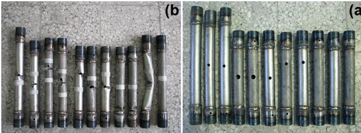
شکل ۳-۴: تعدادی پوسته استوانه ای با طول های متفاوت با و بدون گشودگی، (a) قبل از انجام آزمایش، (b) بعد از انجام آزمایش.
