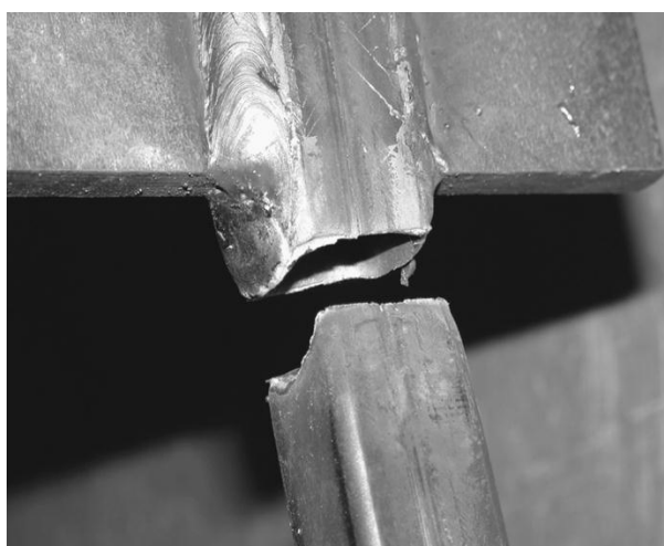
شکل ۳-۲: شکست از ناحیه جوش در پوسته با مقطع قوطی تحت بارگذاری سیکلی [۳۳].
