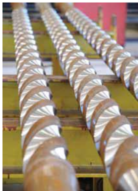
شکل (۲-۱) کاربرد تیر پیچیده شده در پمپها و کمپرسورها
