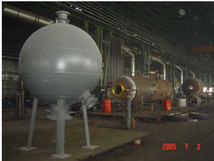
شکل ۱-۸: مخزن ساخته شده به روش شکل دهی انفجاری
