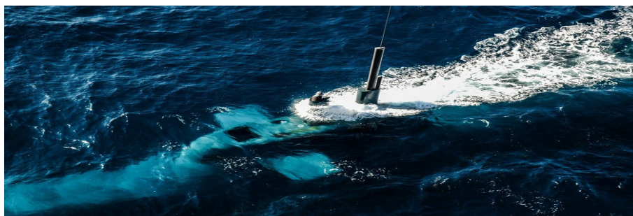
شکل ۱۰.۱: زیر دریایی مدل U-212 aka مجهز به سامانه پیشران‌ش بدون نیاز از هوا
