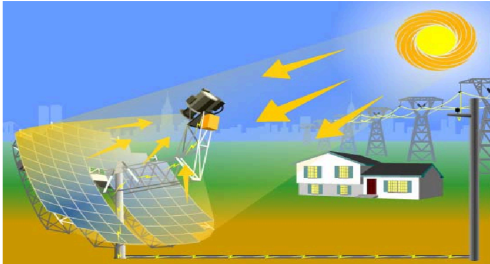
شکل ۸.۱: شماتیکی از سیستم گردآورنده خورشیدی- استرلینگی
