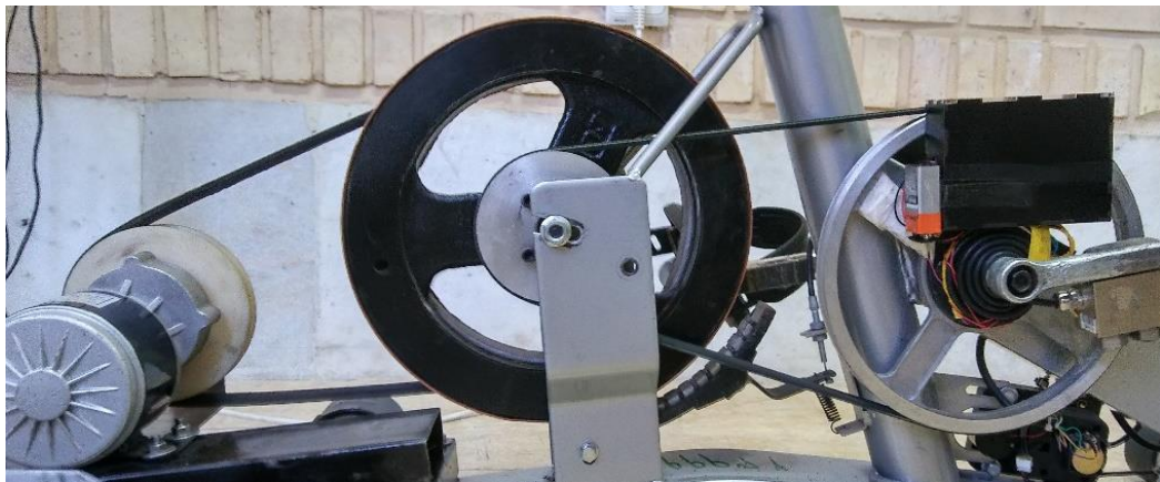
شکل ۲-۱۴: نحوه انتقال قدرت از موتور به پدال توسط دو عدد تسمه
