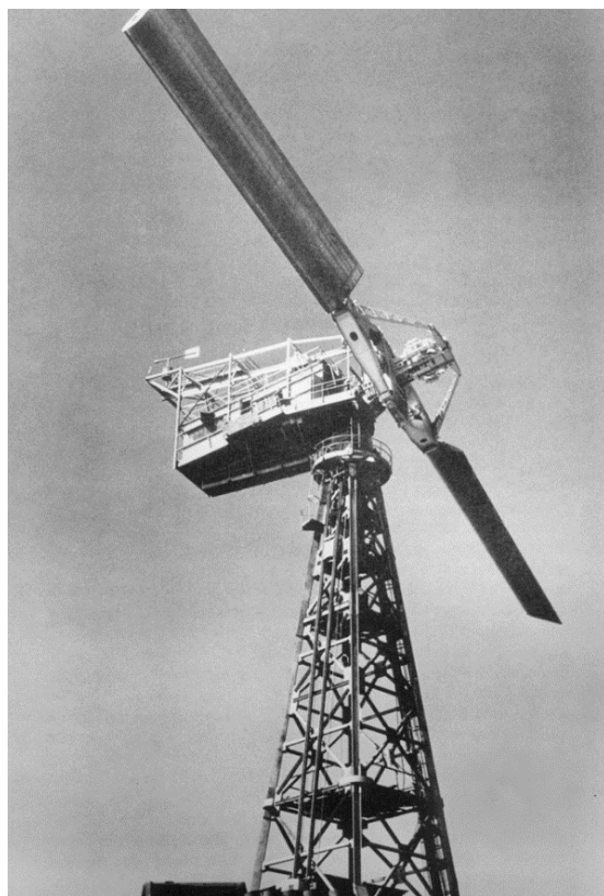
شکل ۱-۶: توربین بادی دو پره‌ای [۱۰]
