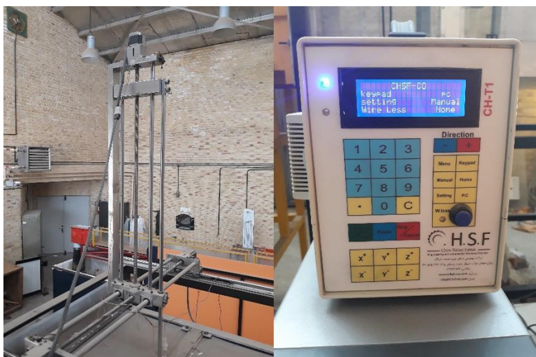
شکل ۳-۱۰: مکانیزم انتقال تغییر جهت پروب
