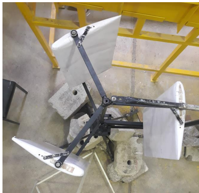
شكل ۳-۲۰: نماي بالاي توربين بادي محور عمود در حالت بدون مكانيزم تغيه گام
