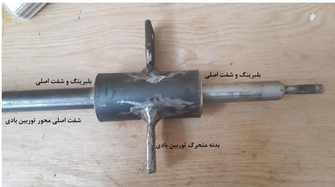
شکل ۳-۱۴: بدنه یا شاسی متحرک، توربین بادی با قسمت‌های نام گذاری شده
