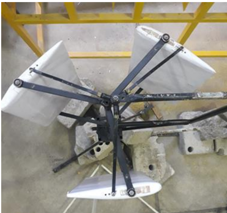
شکل ۳-۲۱: نمای بالای توربین بادی محور عمود در حالت با مکانیزم تغییر گام
