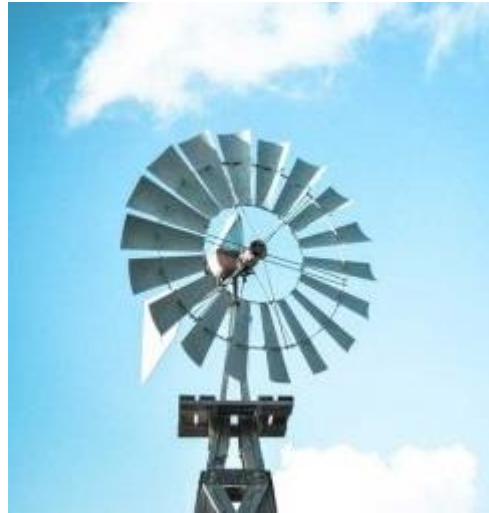
شکل ۱-۵: آسیاب بادی آمریکایی با پره‌های فولادی [۱۰]
