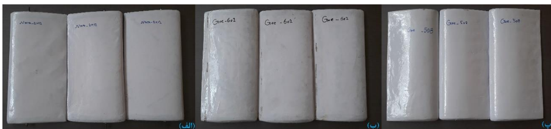
شكل ۳-۱۹: سه نوع ايرفويل نامتقارن ساخت شده از فايبرگلاس (الف) Naca-2412، (ب) Goe-602، (پ) Goe-508
