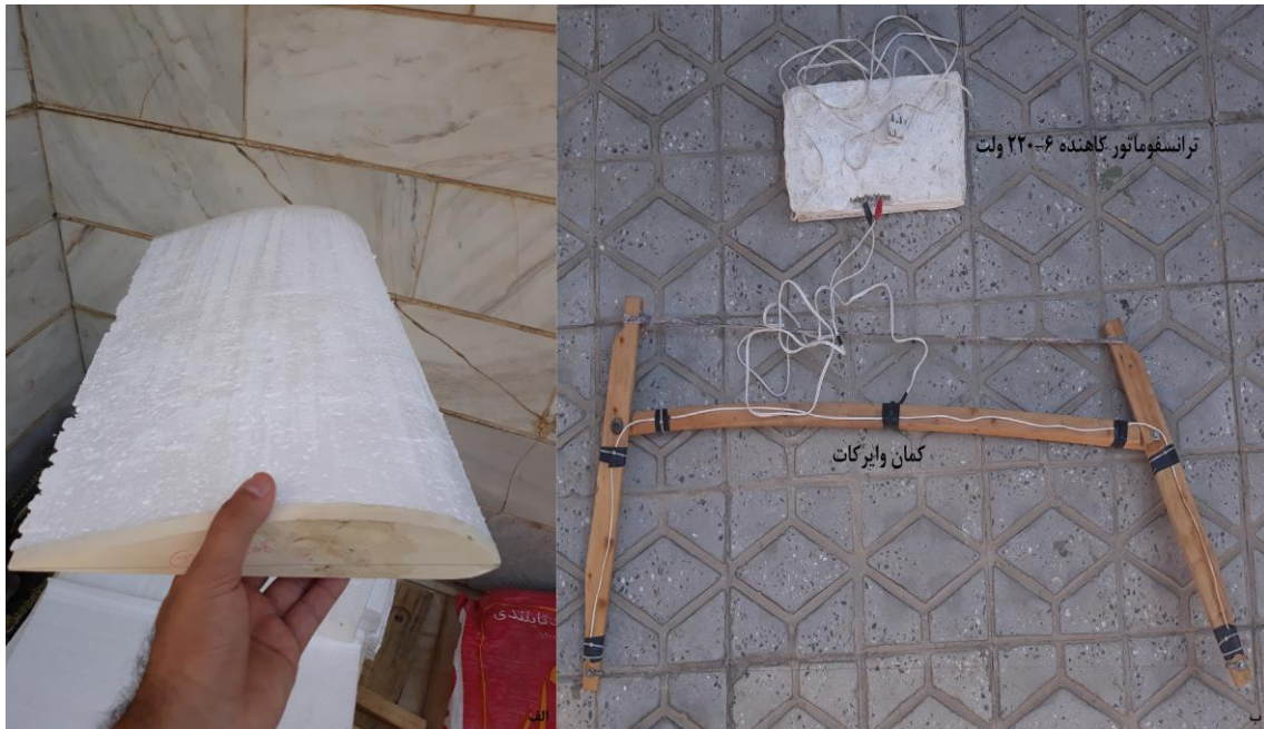
شکل ۳-۱۶: در قسمت (الف) ایرفویل برش داد شده با وایرکات و در قسمت (ب) دستگاه وایرکات و ترانسفورماتور
