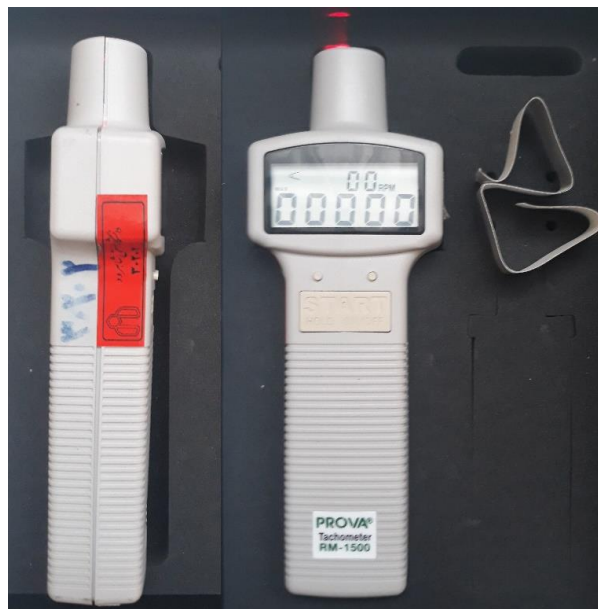
شکل ۳-۱۳: تاکومتر یا دورسنج لیزری همراه با رفلکتور
