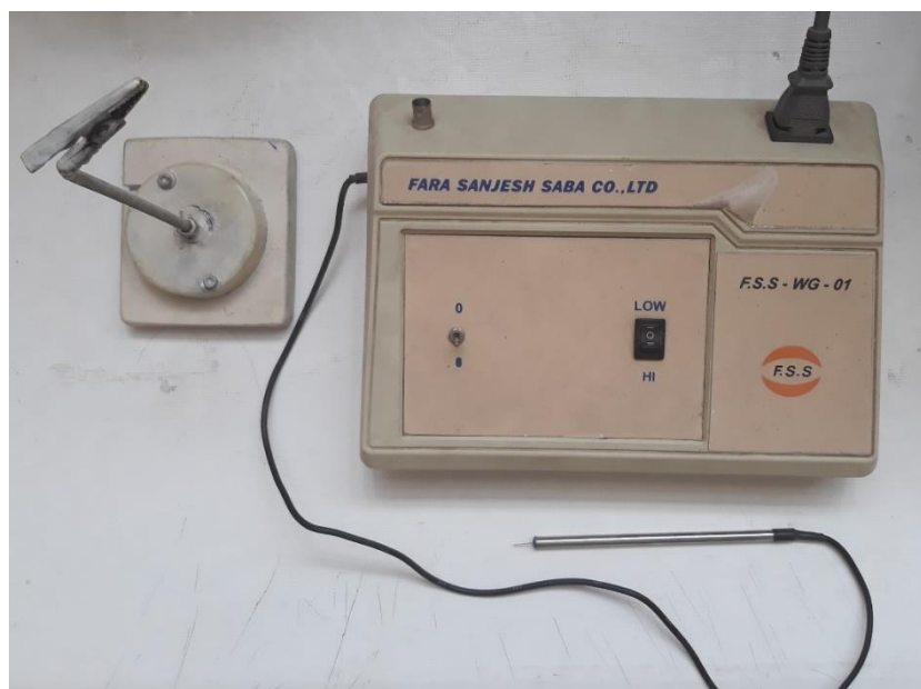
شکل ۳-۹: دستگاه جوش سنسور هات وایر
