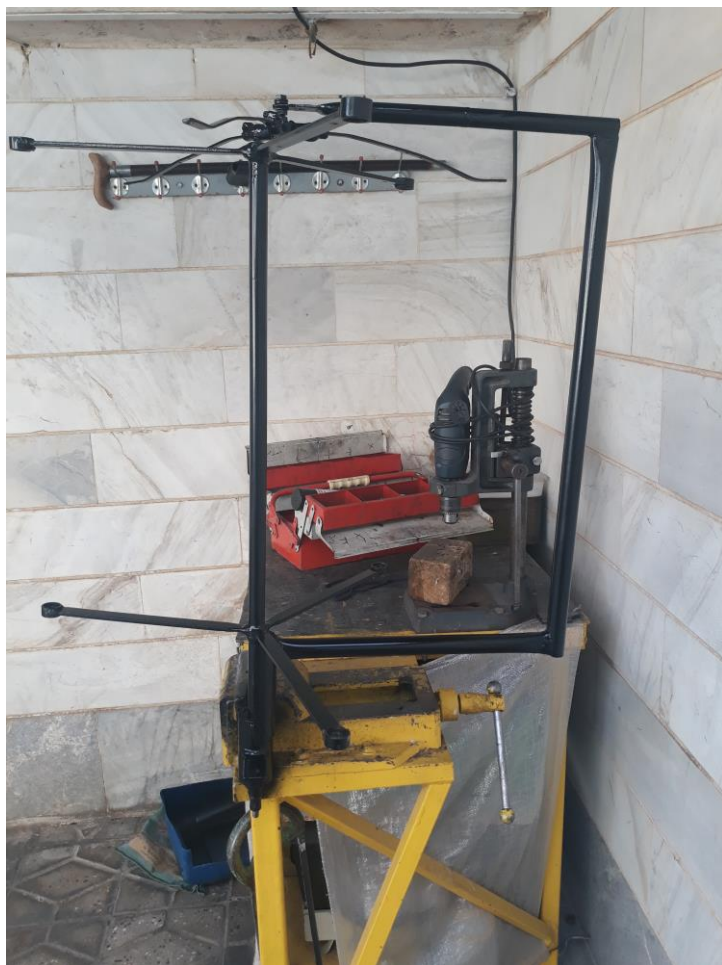
شکل ۳-۱۵: قسمت ثابت بدنه توربین و همراه با قسمت متحرک توربین همراه با سیستم مکانیزم تغییر گام
