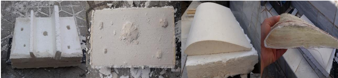
شکل ۳-۱۷: در قسمت (الف) قالب ایرفویل (ب) نحوه‌ی دوغاب کاری ایرفویل (پ) ایرفویل صیقل داده شده و آماده برای فایبرگلاس (ت) فرآیند رزین کاری و چسباندن الیاف پشم شیشه
