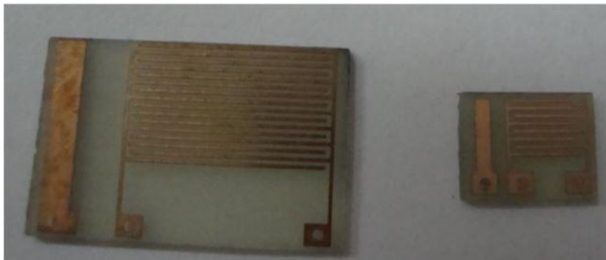
شکل ۵-۱ زیرلایه مورد استفاده در ساخت زیست‌حسگر
