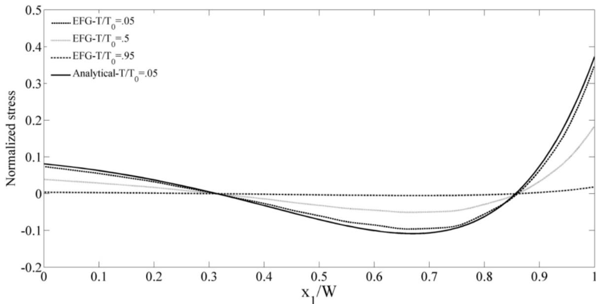
شکل ۱۰-۲- توزیع تنش حرارتی برای تغییر دمای یکنواخت
