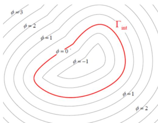
شکل ۳-۵- بیان یک فصل مشترک با استفاده از LSM
