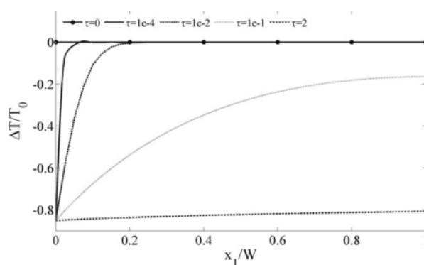
شکل ۴-۳۶- توزیع دمای گذرا در صفحه  $ZrO_2/Ti-6Al-4V$  برای  $p=1$
