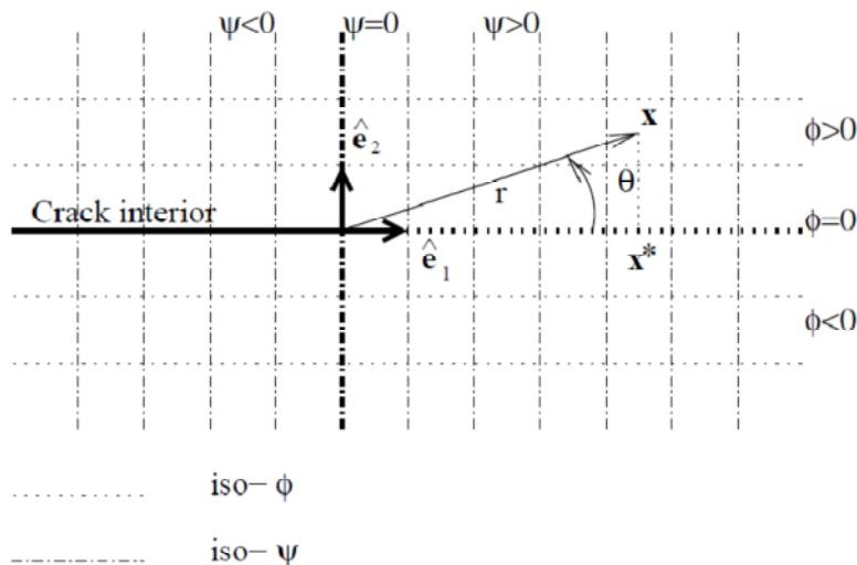
شکل ۳-۶- نمایش توابع  $\phi$  و  $\psi$  بصورت مؤلفه‌های بردار موقعیت نقطه  $x$
