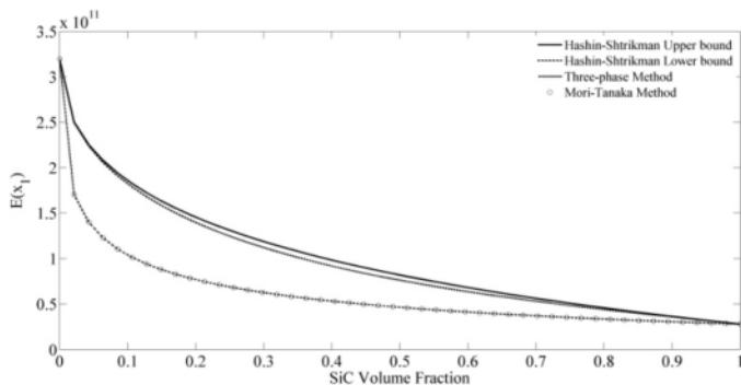
شکل ضالف-۴- تقریب ضریب الاستیسیته با چند مدل میکرومکانیک برای  $\text{SiC}/\text{C}$
