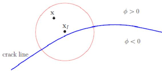
شکل ۸-۳- مجموعه گره‌های  $N^c$ : گره‌هایی که ناحیه تکیه‌گاهی آنها شامل نقطه  $x$  است و ناحیه تکیه‌گاهی آنها توسط ترک بریده می‌شود
