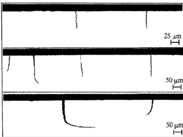
شکل ۲-۱- ترکهای ایجاد شده در سطح سرامیکی FGM تحت شوک حرارتی [۴]
