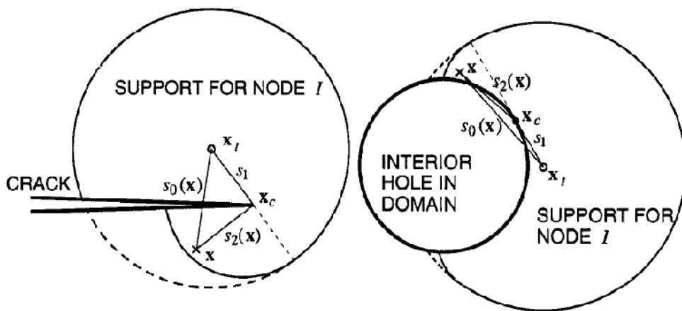
شکل ۳-۳- کاربرد روش پراش برای تصحیح ناحیه تکیه‌گاهی: راست- حول یک سوراخ. چپ- حول یک ترک
