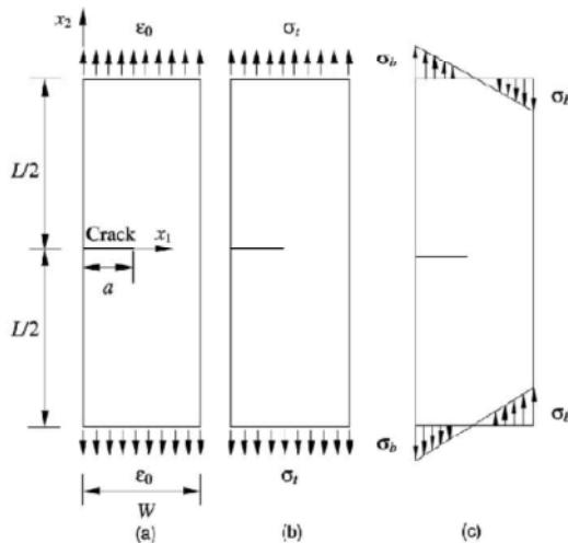
شکل ۱۶-۳- هندسه و بارگذاری FGP حاوی ترک لبه‌ای. (a) کرنش ثابت. (b) تنش کششی ثابت. (c) تنش خمشی مدول الاستیسیته بصورت تابع نمایی در نظر گرفته می‌شود .
