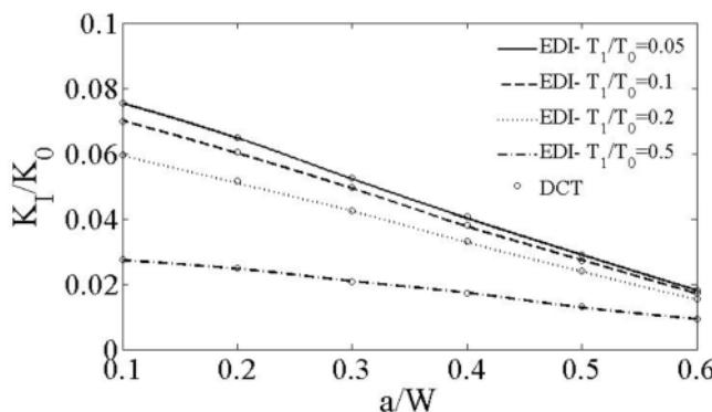
شکل ۱۳-۴- ضرایب شدت تنش بر حسب طول ترک و دمای لبه بدون ترک. حالت تنش صفحه‌ای، ( $WP_E = \ln(10)$ ،  $T_2/T_0 = 0.5$  و  $WP_k = \ln(10)$  ،  $WP_a = \ln(2)$ )
