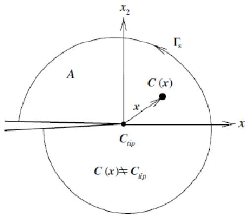
شکل ۱-۵- تفاوت تانسورهای ساختاری  $C(x)$  و  $C_{tip}$
