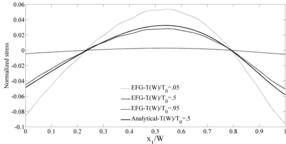
شکل ۱۱-۲- توزیع تنش حرارتی برای دمای ثابت لبه چپ ( $T_0$ ) و تغییر دمای لبه راست
