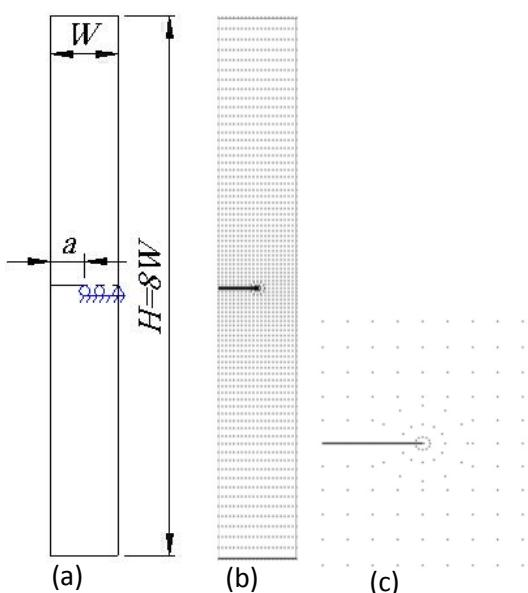
شکل ۹-۵- نمای کلی از FGP حاوی ترک عمود بر لبه. (a): هندسه صفحه تحت بارگذاری. (b): گرهبندی کل ناحیه. (c): گرهبندی نوک ترک.
