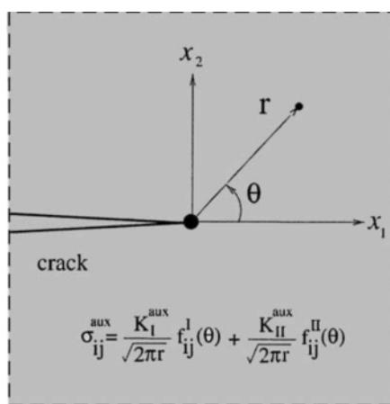
شکل ۲-۵- پیوستار دو بعدی FGM شامل ترک و دستگاههای مختصات دکارتی و قطبی نوک ترک و میدانهای کمکی ضریب شدت تنش
