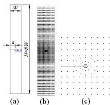
شکل ۳-۱۷-۳- نمای کلی از (a) هندسه (b) گرهبندی کامل (c) گرهبندی نوک ترک برای FGP
