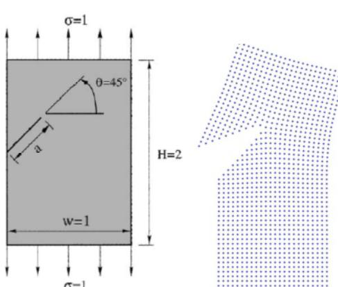
شکل ۳-۲۲-۳- هندسه و تغییر شکل یافته صفحه محدود FGM حاوی یک ترک مایل
