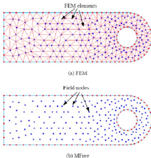
شکل ۱-۳- مدل گسسته هندسه در روش المان محدود (بالا) و روش‌های بدون المان (پایین) [۱۰].
