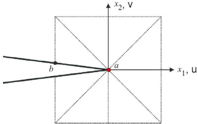
شکل ۳-۱۰-۳ - کاربرد روش همبستگی تغییرمکان برای یک نقطه همبستگی
