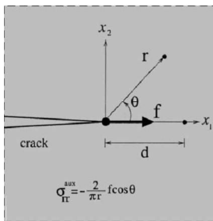
شکل ۳-۵- میدان‌های حاصل از اعمال یک بار نقطه‌ای به نوک یک ترک نیمه بینهایت واقع در محیط بینهایت همگن (میدان‌های کمکی تنش T)
