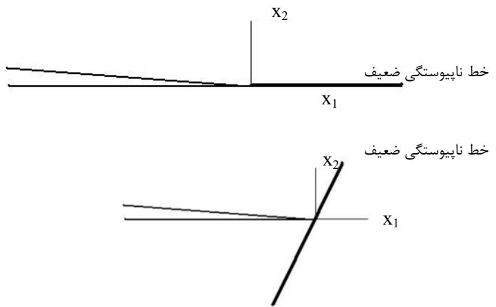
شکل ۱-۴- موقعیت ترک نسبت به خط ناپیوستگی ضعیف. بالا: ترک فصل مشترک. پایین: حالت کلی.
