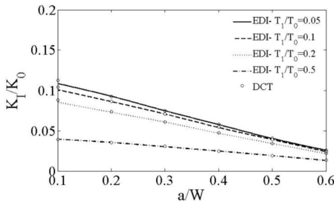
شکل ۱۲-۴- ضرایب شدت تنش بر حسب طول ترک و دمای لبه بدون ترک. حالت کرنش صفحه‌ای، ( $WP_E = \ln(10)$ ،  $T_2/T_0 = 0.5$  و  $WP_k = \ln(10)$  ،  $WP_a = \ln(2)$ )
