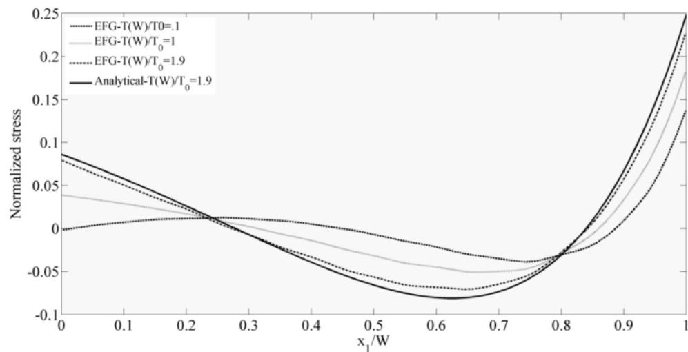
شکل ۱۲-۲- تغییرات توزیع تنش حرارتی برای دمای ثابت لبه چپ ( $0.5T_0$ ) و تغییر دمای لبه راست
