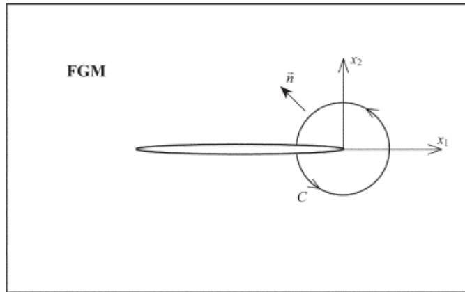
شکل ۲-۴- صفحه FGM حاوی ترک نمایش کانتور  $C$  حول نوک ترک
