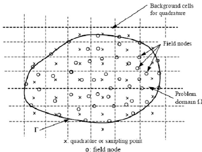
شکل ۲-۱-۲- شبکه‌بندی زمینه در روش‌های بدون مش روی کل ناحیه. نمایش ناحیه حل با گره‌ها و استفاده از شبکه‌بندی زمینه [۱۰]
