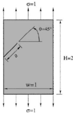
شکل ۸-۵- هندسه و بارگذاری صفحه محدود FGM حاوی یک ترک مایل
