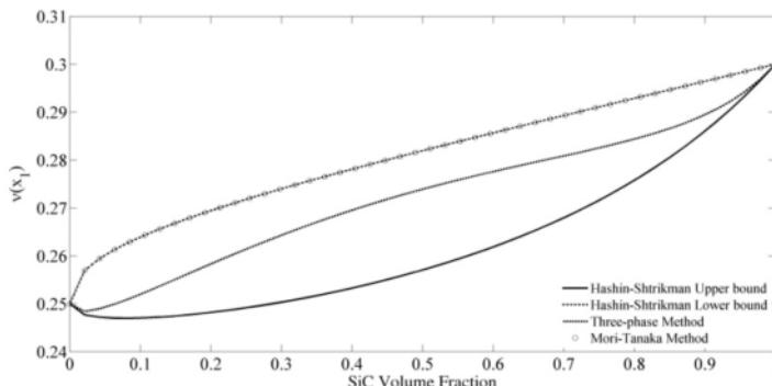
شکل ضالف-۵- تقریب ضریب پواسون با چند مدل میکرومکانیک برای  $\text{SiC}/\text{C}$
