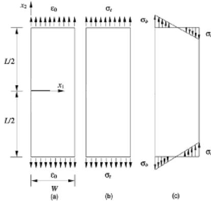
شکل ۴-۲ یک صفحه از جنس FGM تحت بار مکانیکی - (a) بارگذاری کرنش ثابت-(b) بارگذاری کشش-(c) بارگذاری گشتاور خمی
