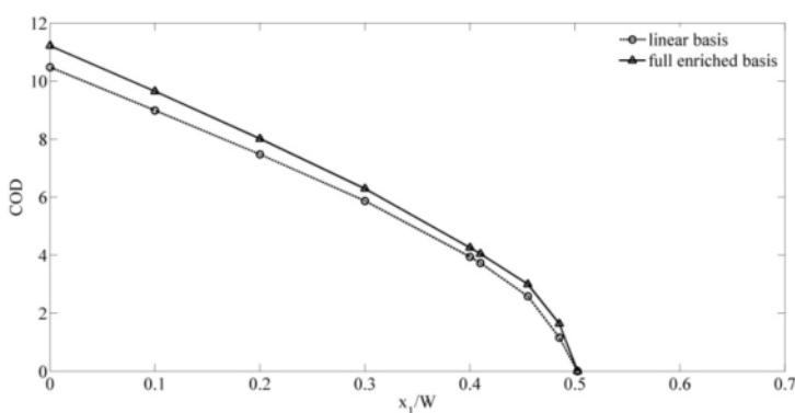
شکل ۳-۱۹-۳ - مقایسه بازشدگی سطح ترک برای توابع پایه خطی و غنی‌شده بازشدگی سطح ترک بر حسب  $E(0)/E(W)$  در شکل (۲۰-۳) آمده است. مطابق شکل، برای مقادیر کمتر  $E(0)/E(W)$  (صفحات با مواد نرمتر) بازشدگی سطح ترک بیشتر است.
