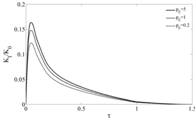
شکل ۳۱-۴- اثر تغییر توان پروفیل مدول الاستیسیته ( $p_E$ ) روی ضریب شدت تنش
