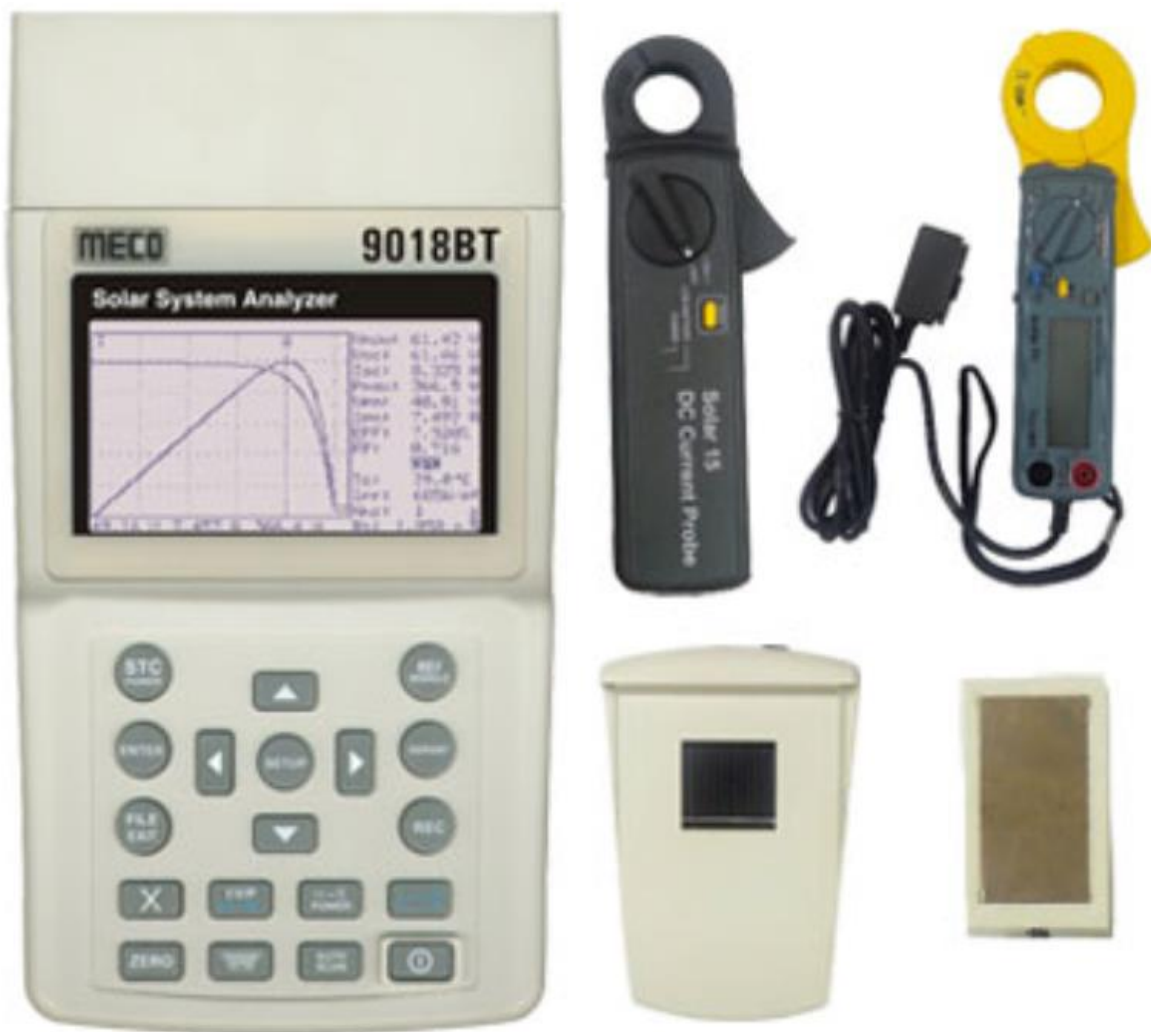
شکل ۳-۵ دستگاه اندازه گیری راندمان تجهیزات برق خورشیدی
