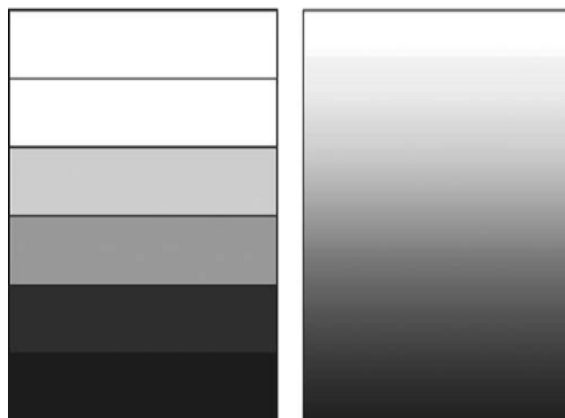
شکل ۱-۱۹: شکل سمت راست ماده مدرج تابعی و سمت چپ یک کامپوزیت [۲]
