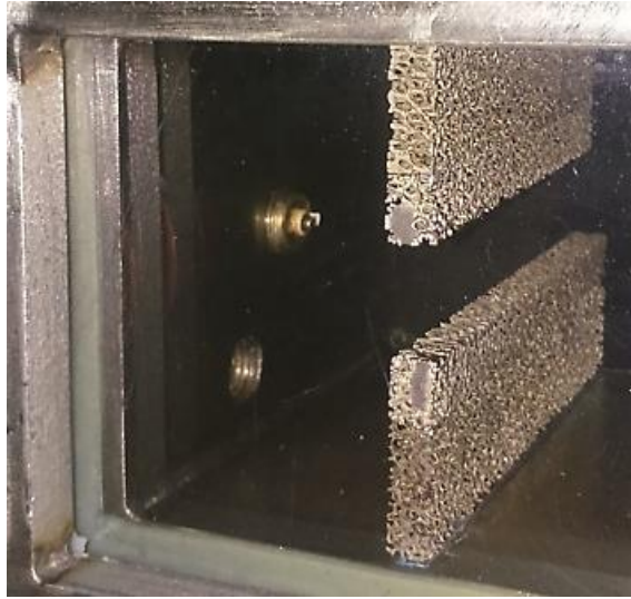
شکل ۳-۸- نحوه قرارگیری مانع با ارتفاع ۳۰ mm در فاصله ۵ cm در داخل محفظه
