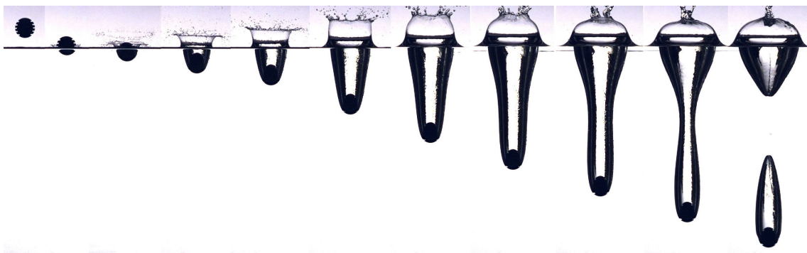
شکل ۴-۳۲: برخورد گوی با شناسه S_{5,0} به سطح آب، دمای سطح گوی ۲۵ درجه سانتی‌گراد، (U_0 = 3.13 \text{ [m.s}^{-1}\text{]}, B = 13.6, W = 13\text{[mm]}, Fr = 1\text{[mm]}, Re_0 = 702\text{[mm]}, D_0 = 20 \text{ [mm]})
