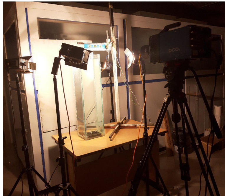
شکل ۳-۲: تصویربرداری از سقوط گوی‌ها در آب با لنز ۱۰۵ میلی‌متری
