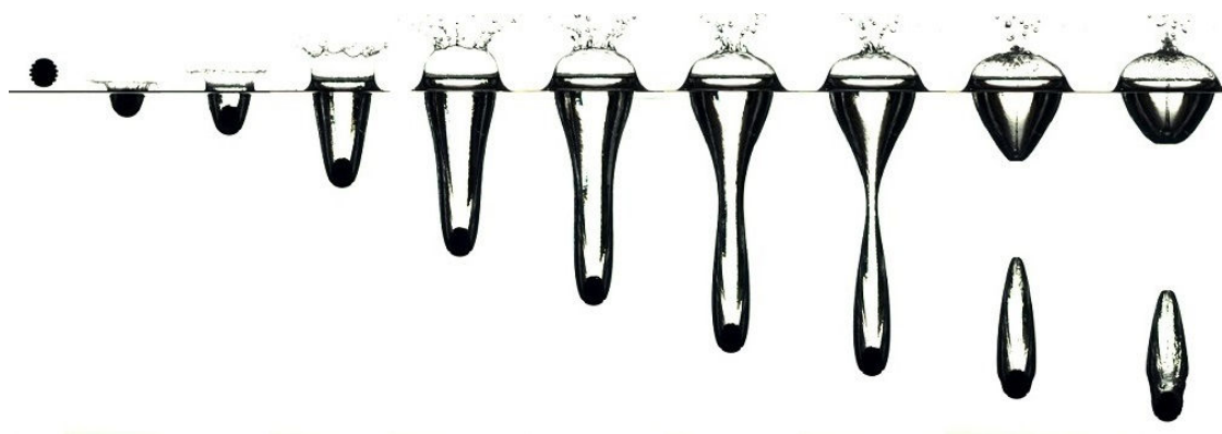
شکل ۳-۹: تصویر نیمه عریض از تشکیل کاواک بعد از برخورد گوی دارای شیار به سطح آب
