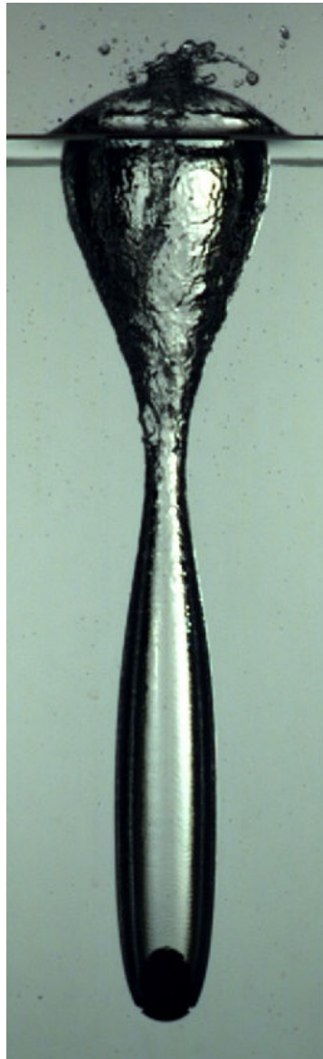
شکل ۲-۴: کاواک قبل از لحظه جدایش. U_0 = 4.42 \text{ [m.s}^{-1}\text{]} , B = 13.6 , W = 27^\circ , Fr = 2^\circ , Re_0 = 993^\circ , D_0 = 2^\circ \text{ [mm]}
