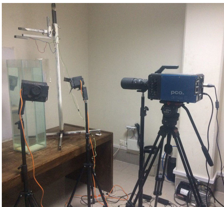
شکل ۳-۳: تصویربرداری از سقوط گوی‌ها در آب با لنز ۲۰۰ میلی‌متری
