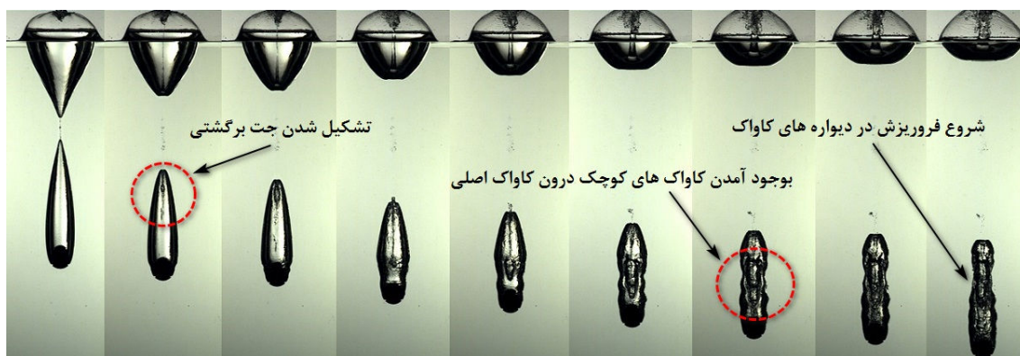
شکل ۴-۳۳: چگونگی تشکیل شدن جت برگشتی در برخورد گوی با شناسه S_{5,0} به سطح آب، (U_0 = 3.13 \text{ [m.s}^{-1}\text{]}, B = 13.6, W = 13\text{ }\square, Fr = 1\text{ }\square, Re_0 = 702\text{ }\square, D_0 = 2\text{ }\square \text{ [mm]})
