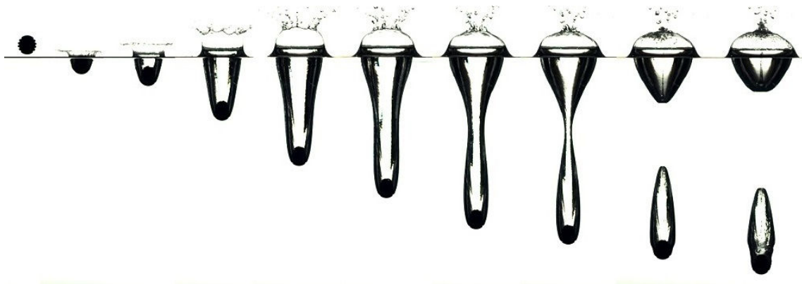
شکل ۲-۳: برخورد گوی با سطح دارای شیار به سطح آب و تشکیل کاواک
