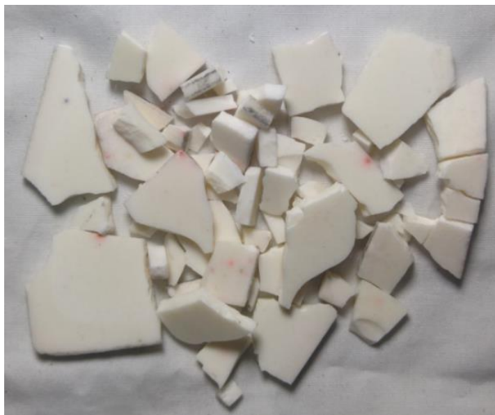
شکل ۲-۵ خردشدگی سرامیک در آزمون ۱ (CC3B2) با سرعت برخورد 244/8 m/s
