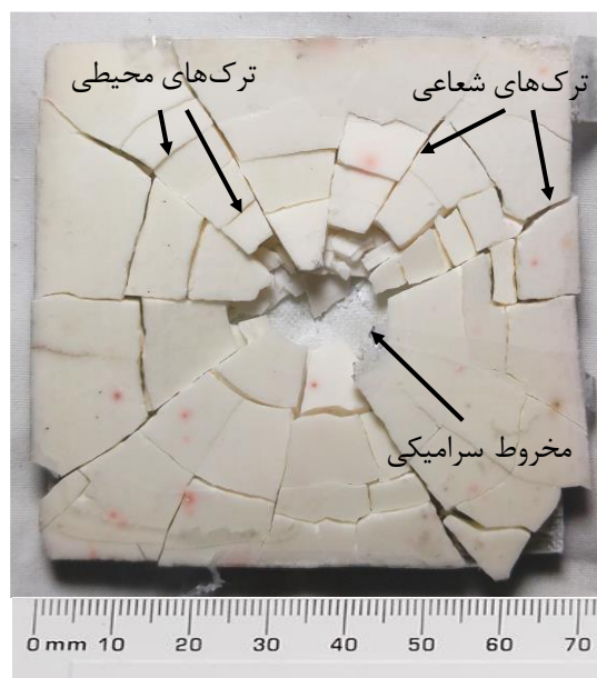
شکل ۵-۸ شکست سرامیک نمونه CC3B4 با سرعت برخورد 368/9 \text{ m/s} در آزمون شماره ۴
