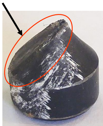
شکل ۵-۷ پرتابه فرسایش یافته آزمون ۳ پس از برخورد با سرعت 368/9 \text{ m/s} به هدف CC3B2
