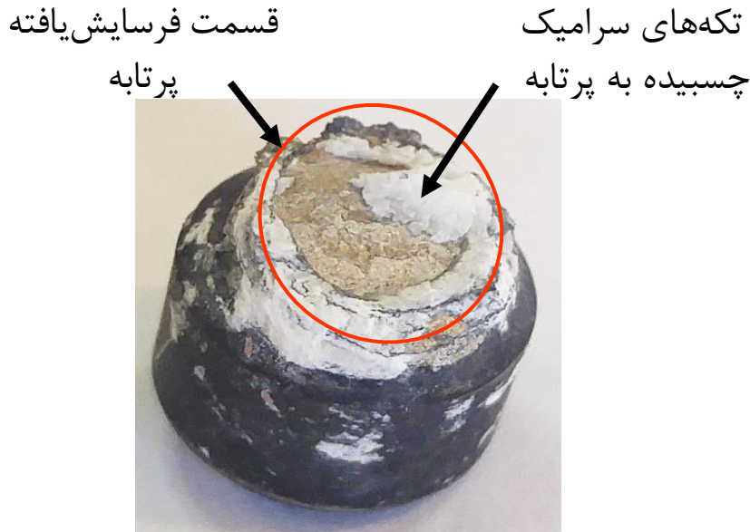
شکل ۵-۱۰ پرتابه فرسایش یافته آزمون ۴ پس از برخورد با سرعت 368/9 m/s به هدف CC3B4
