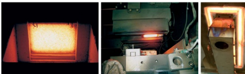
شکل (3-13): پیش گرمایش قالب های ریخته گری توسط مشعل متخلخل
