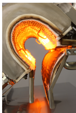
شکل (3-12): گرمایش لوله های پلاستیکی توسط مشعل متخلخل
