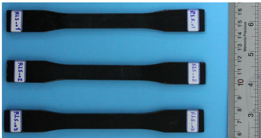
شکل ۳-۱۰- نمونه‌های آزمون کشش رزین نانوذرات تک‌لایه‌ی گرافن اکساید
