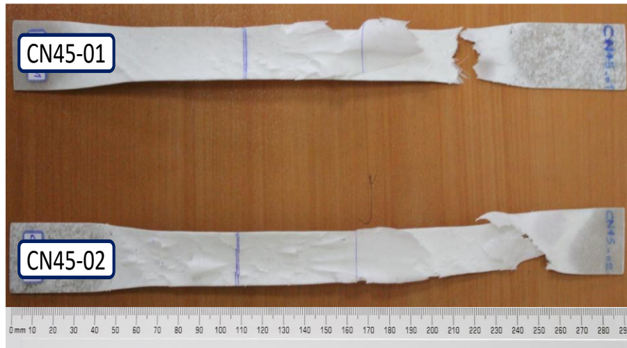
شکل ۴-۸- نمونه‌های کامپوزیتی با زاویه الیاف 45^\circ بدون نانوذرات گرافن پس از کشش
