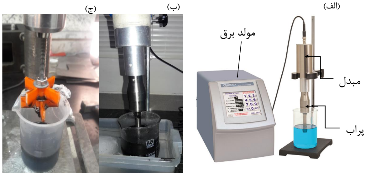
شکل ۳-۵-الف) دستگاه آلتراسونیک Sonicator-Q700، ب) توزیع نانوگرافن در رزین اپوکسی و داخل محلول آب و یخ با دستگاه آلتراسونیک، ج) همزن مکانیکی
