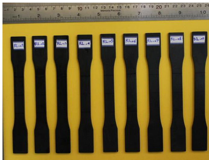
شکل ۳-۸- نمونه‌های ساخته‌شده با انواع مختلف نانوذرات گرافن
