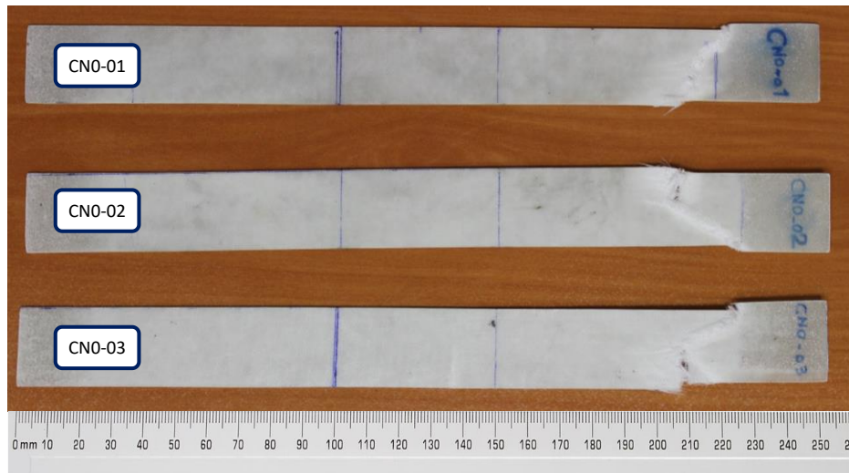
شکل ۴-۹- نمونه‌های هسته‌ی کامپوزیتی با زاویه الیاف صفر درجه بدون نانوذرات گرافن پس از انجام آزمون کشش
