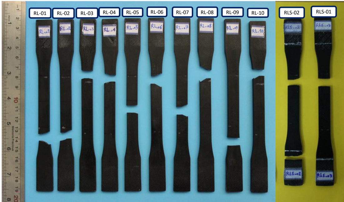
شکل ۴-۳- نمونه‌های آزمون کشش رزین برای انتخاب نوع بهینه نانوگرافن پس از انجام آزمون کشش
