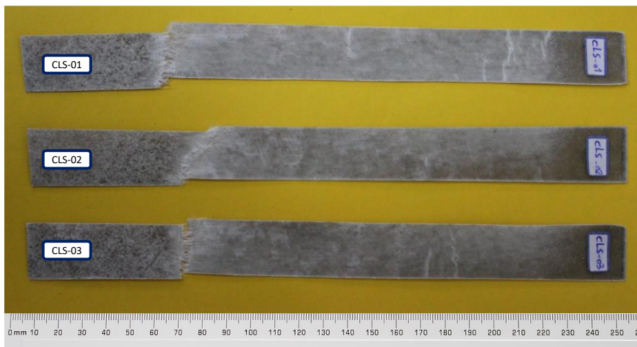
شکل ۱۱-۴- نمونه‌های هسته‌ی کامپوزیتی با نانوگرافن تک لایه پس از انجام آزمون کشش
