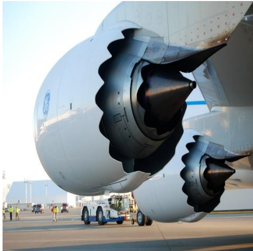
ب- موتور جت و نازل خروجی هواپیمای بوئینگ ۷۳۷
