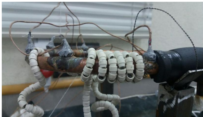
شکل (۴-۲) نمایی از هیتر الکتریکی و نحوه قرار گرفتن آن روی لوله
