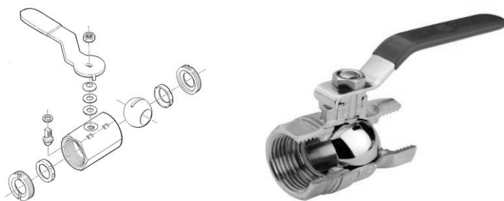
شکل ۲-۱۳: مکانیسم شیر ورودی
