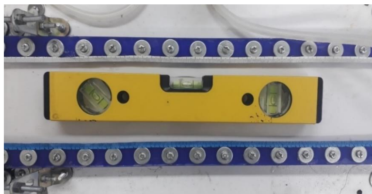
شکل ۲-۳: تراز کردن تجهیز آزمایشگاه
