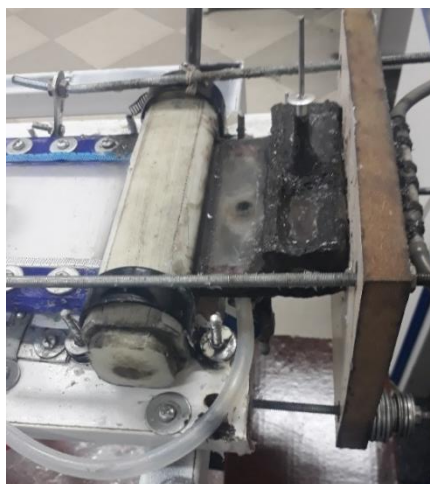
شکل ۲-۱۷: نحوه‌ی اتصال کلکتور به سلول هل-شاو
