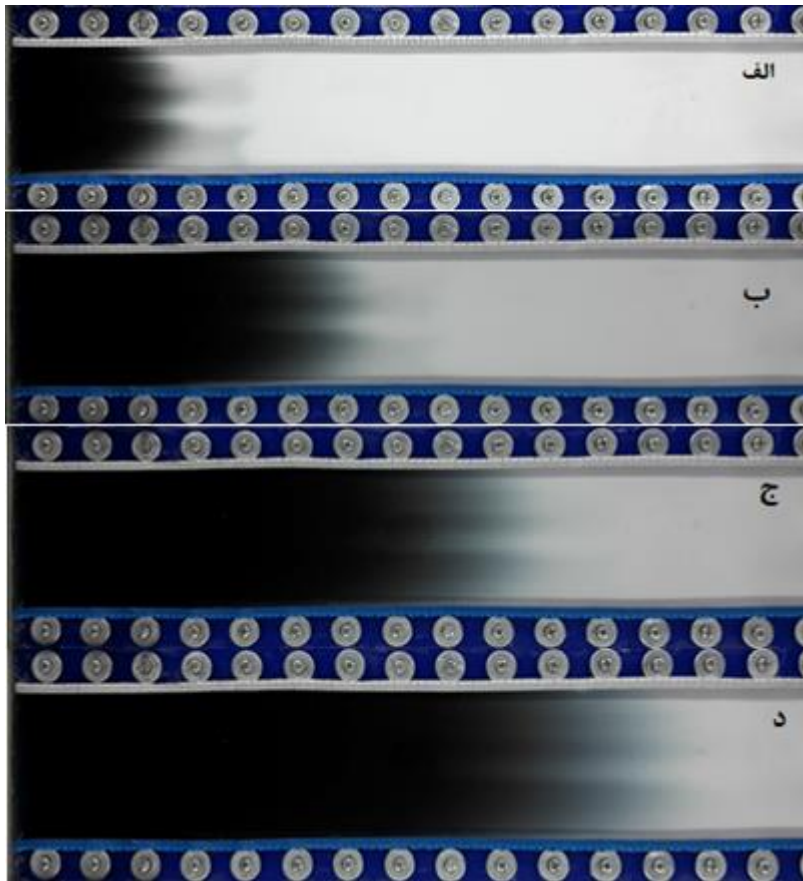
شکل ۲-۱۹: صحت‌سنجی موازی بودن سلول در تمام نقاط و ثبت تصاویر در لحظات الف) ۱۰۰ ثانیه ب) ۱۶۰ ثانیه ج) ۲۲۰ ثانیه د) ۲۵۰ ثانیه
