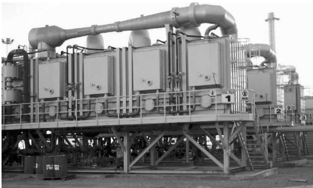
شکل ۱-۱۰: نمایی از یک آب شیرین کن چند مرحله‌ای گرمایی [۱۴]
