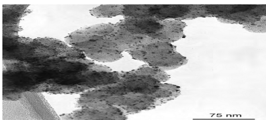
شکل ۱-۶: ایجاد ساختاری متخلخل برای افزایش سطح [۱].
