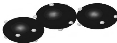
شکل ۱-۲۲: نمایش ایده آل کاتالیزور پلاتین که به صورت ذرات بسیار ریز روی سطحی از کربن پودر شده قرار گرفته اند که ذرات سیاه رنگ کربن پودر شده و ذرات سفید رنگ پلاتین می باشند [۱].
