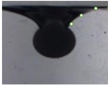
شکل ۲-۴ انحناى کویتى در بیشترین عمق نفوذ ذره در شرایط بحرانی
