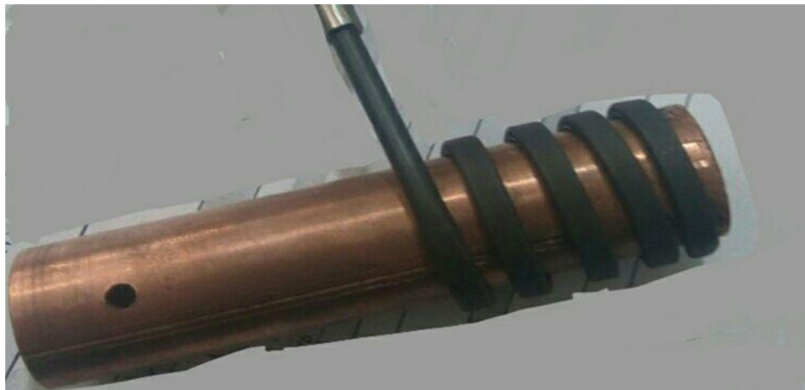
شکل ۲-۳: کویل هیتر استفاده شده در نیمه‌ی پایینی استوانه‌ی مسی با توان ۳۰۰ وات.
