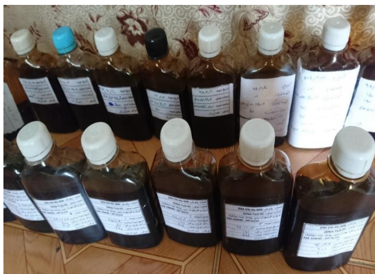
شکل ۴-۱۱- نمونه‌های روغن مورد آزمایش در ساعت‌های مختلف کارکرد در آزمون‌های موتوری
