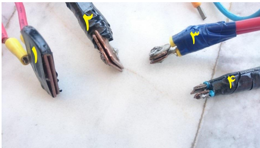
شکل ۳-۵- حسگر خازنی صفحه موازی با الکترودهای مختلف
