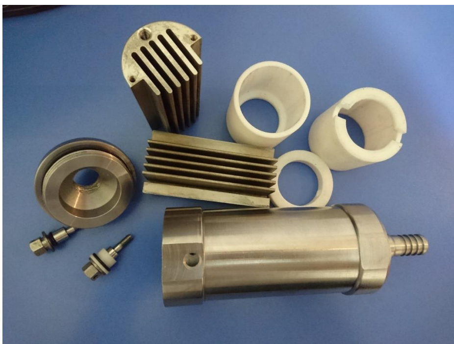
شکل ۳-۱۲- اجزای تشکیل‌دهنده حسگر
