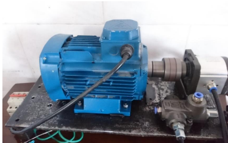
شکل ۴-۱۴- پمپ هیدرولیک مورد استفاده با حداکثر تحمل فشار ۲۰ BAR
