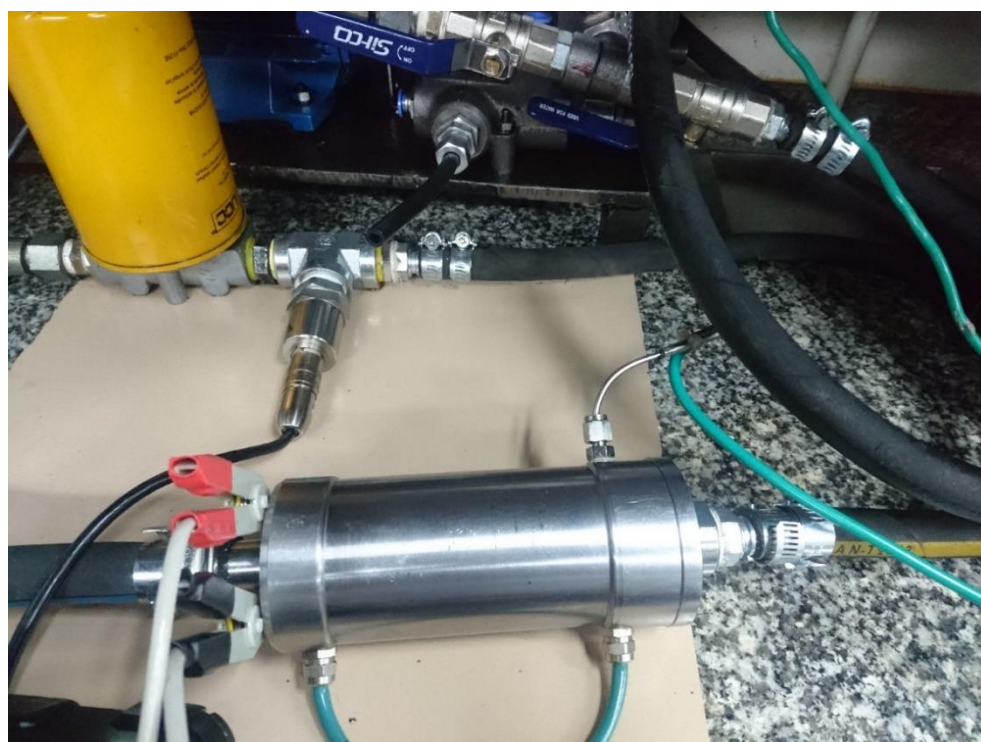
شکل ۴-۱۹- نصب حسگر ساخته شده و TAN DELTA به طور همزمان در مدار هیدرولیک
