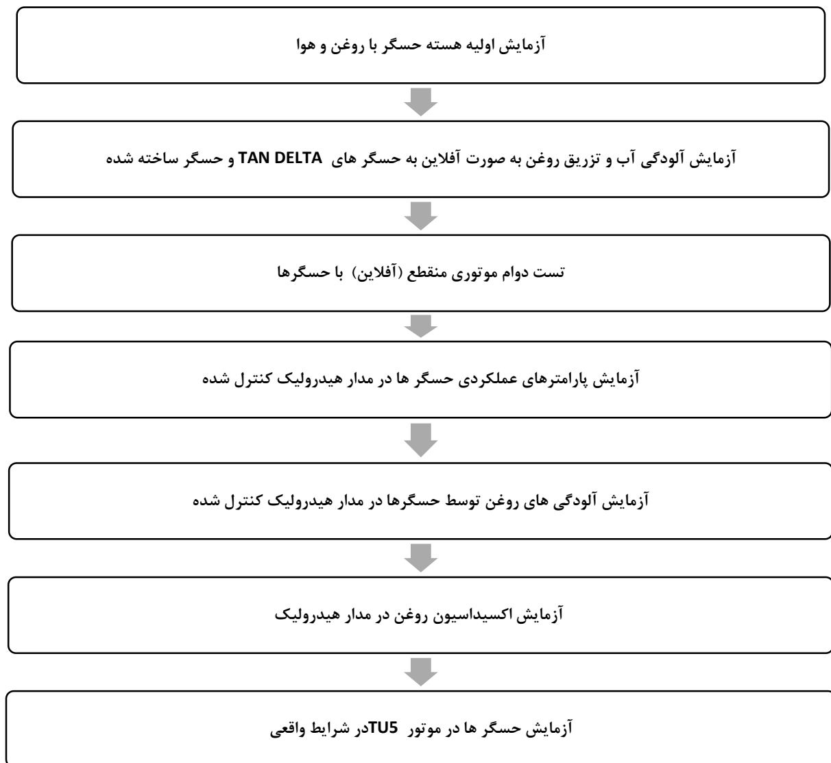
شکل ۱-۴- فلوچارت مراحل آزمایش حسگر شانه‌ای
