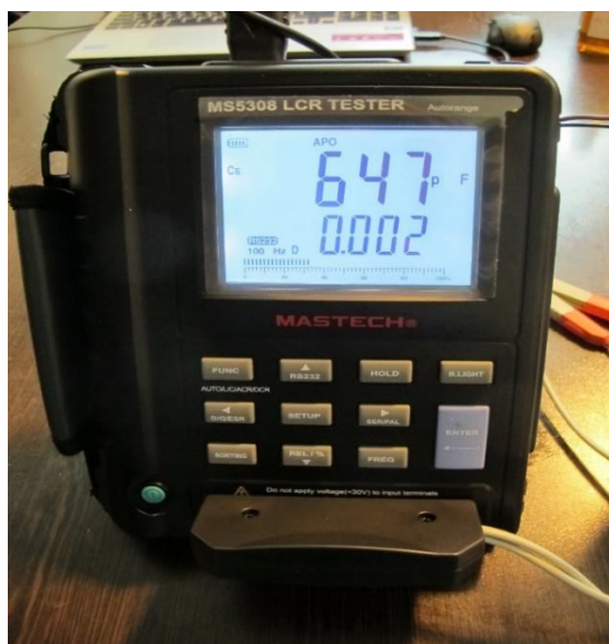
شکل ۴-۲- دستگاه اندازه‌گیری ظرفیت خازنی و مقاومت LCR METER MASTECH 5308
