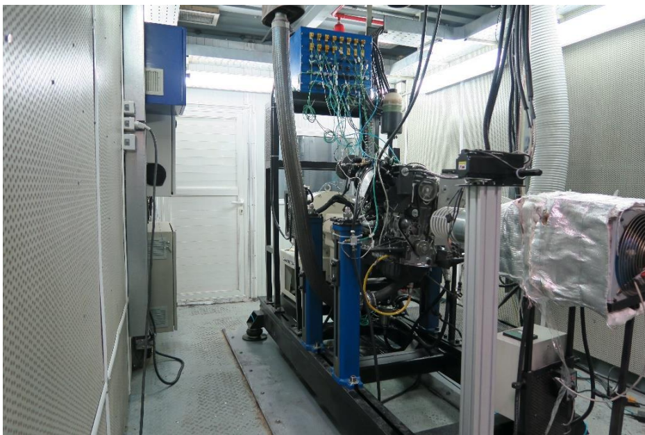
شکل ۴-۶- نمایی از آزمون دوام موتورها در اتاق آزمون دینامومتری با روغن‌های مشخص
