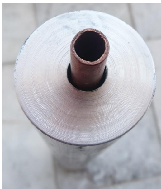
شکل ۳-۶- حسگر خازنی استوانه‌ای
