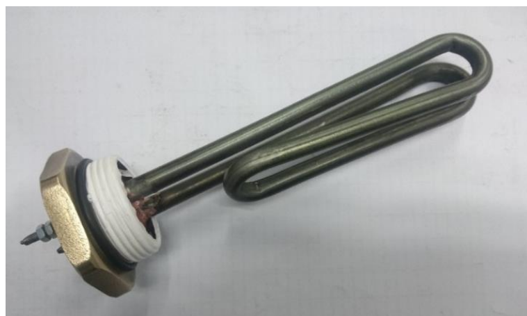
شکل ۴-۱۵- گرمکن روغن مورد استفاده در مدار هیدرولیک
