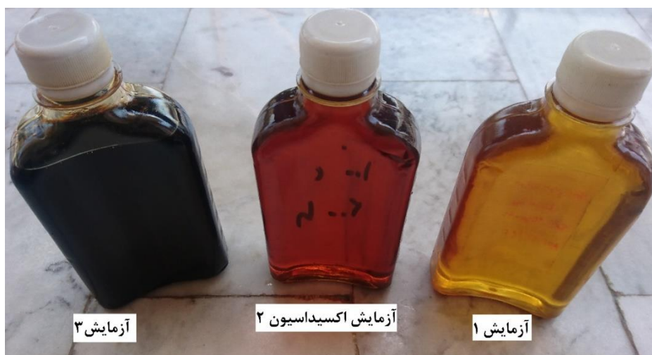
شکل ۵-۳۸- تغییر رنگ نمونه روغن پس از آزمایش‌های اکسیداسیون
