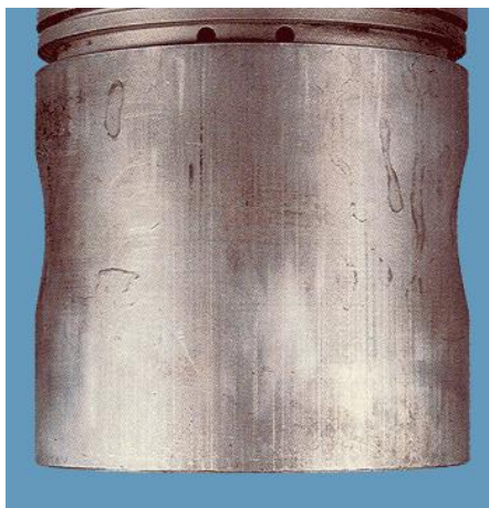
شکل ۱-۱ - خرابی پیستون بر اثر ذرات سایشی در روغن [۳]
