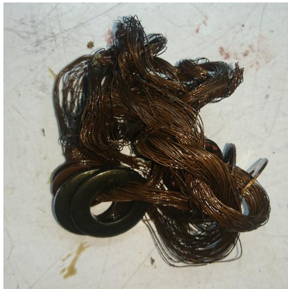
شکل ۴-۲۳- سیم‌های مسی مورد استفاده برای تسریع فرایند اکسیداسیون روغن
