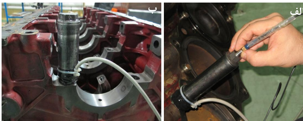
شکل ۳-۶ اندازه‌گیری زمان انتشار موج اولتراسونیک به همراه وایر نیروسنج (الف) پیچ بلند سرسیلندر (ب) پیچ یاتاقان کپه
