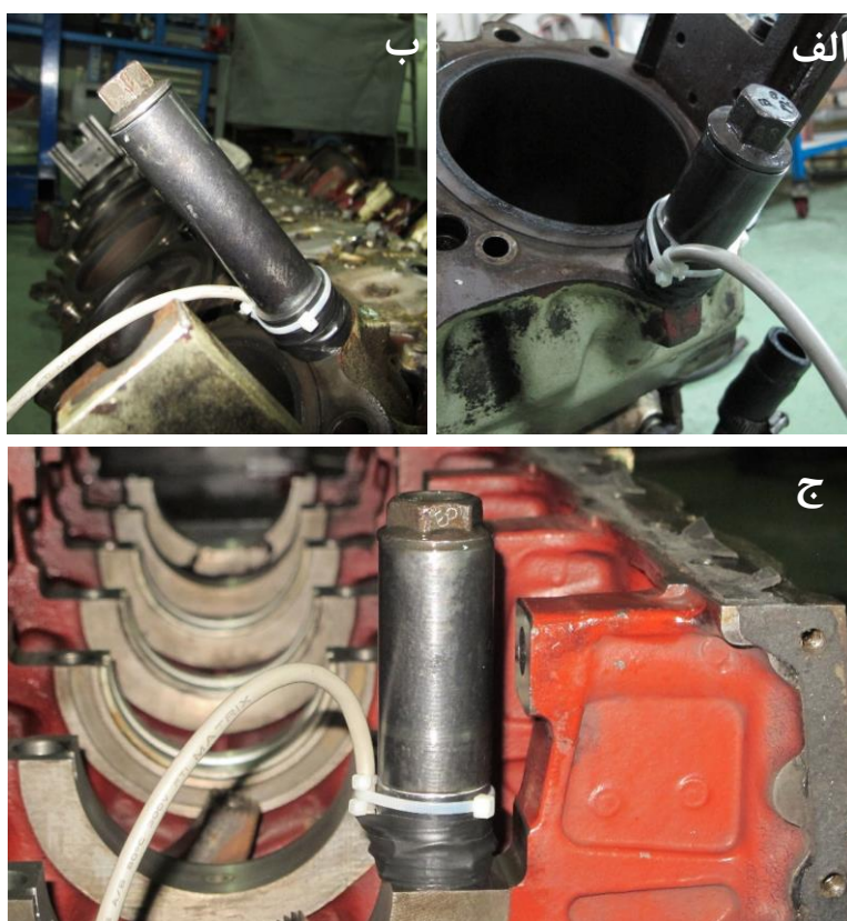
شکل ۳-۵ اندازه‌گیری نیروهای همبندی پیچ‌های الف) کوتاه سرسیلندر ب) بلند سرسیلندر ج) یاتاقان کپه
