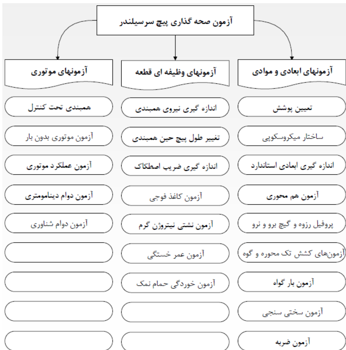
شکل ۲-۵ آزمون‌های صحنه‌گذاری پیچ سرسیلندر
