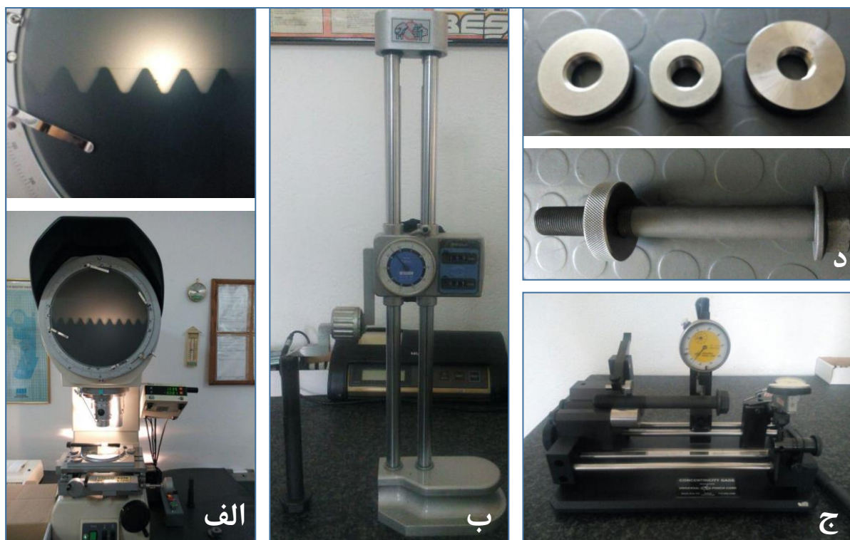
شکل ۴-۷ فرایندهای کنترل ابعادی و هندسی پیچ‌های ساخته شده (الف) کنترل پروفیل رزوه (ب) کنترل ابعادی (ج) کنترل لنگی (د) کنترل انطباقات
