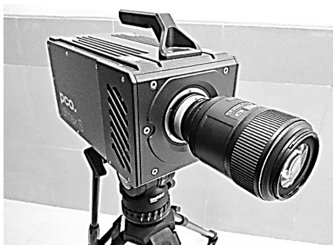
شکل ۲-۲۰- دوربین سرعت بالا مدل Dimax S/4500 frames per second از شرکت PCO
