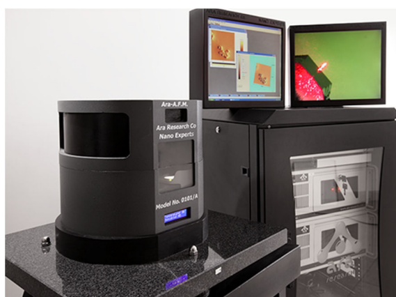
شکل ۲-۱۴ دستگاه AFM برای اندازه‌گیری زبری سطح
