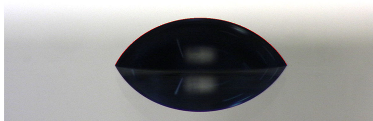
شکل ۳-۱۴ زاویه تماس قطره آب با سطح پلکسی گلس
