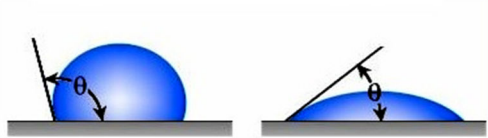
شکل ۷-۱ زاویه تماس جامد-مایع: بر روی سطوح آبدوست (سمت راست) و آب‌گریز (سمت چپ).
